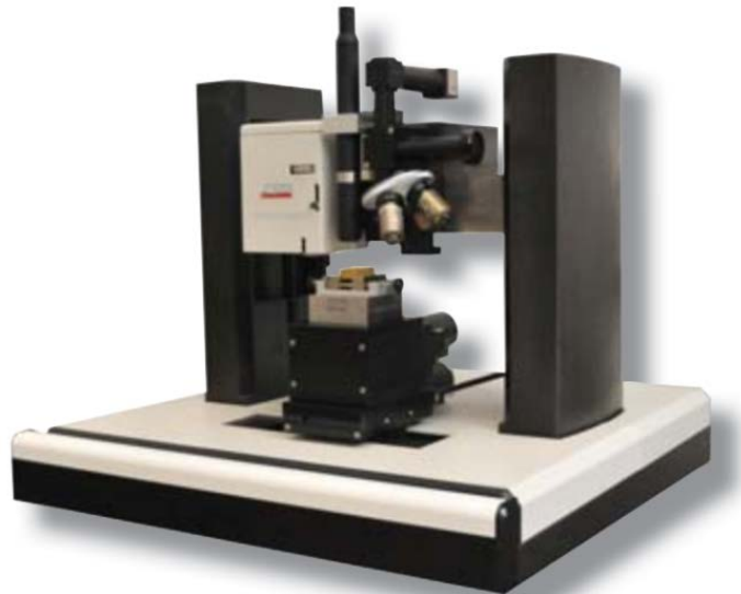
Obr. 21 – Přístroj Micro-Combi Tester pro měření mikrotvrlosti [25]
