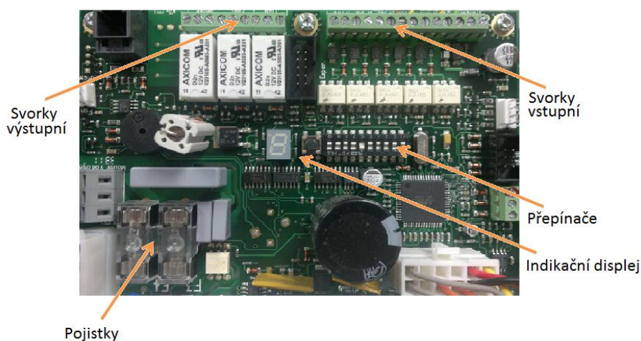
Obr. 11 Popis řídicí jednotky [9] upravil Urban 2015
