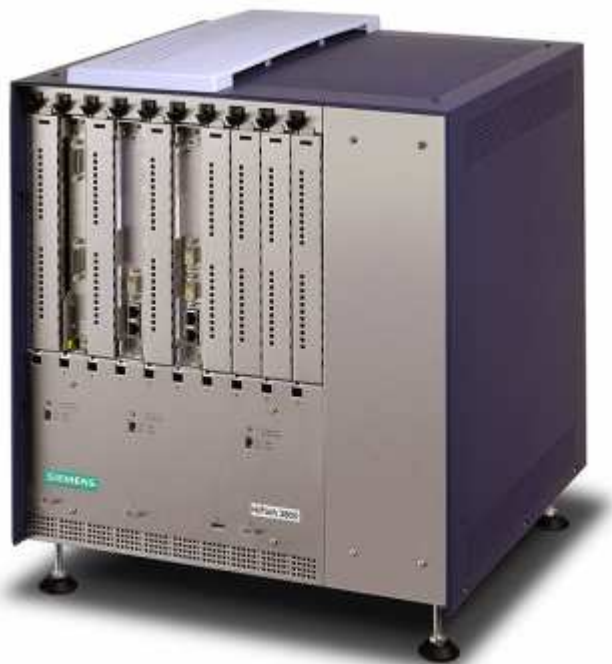
Obr. 12. Stávající telefonní ústředna centrála [20].
