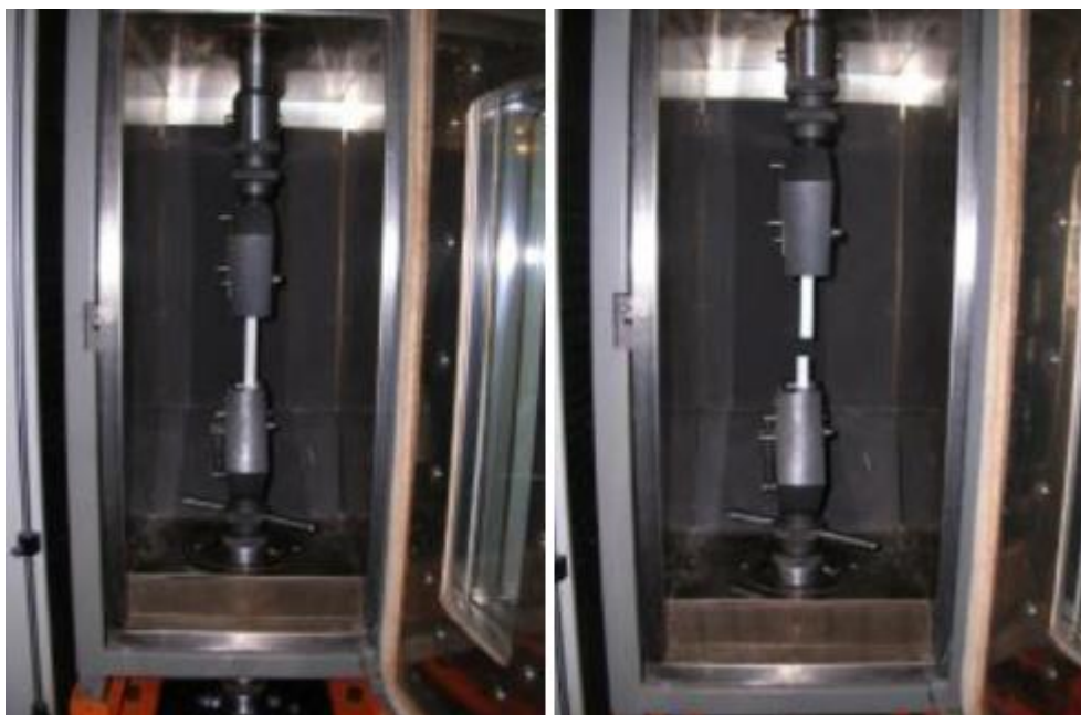
Obr. 14 Okamžik před přetržením a po přetržení zkušební vzorku
