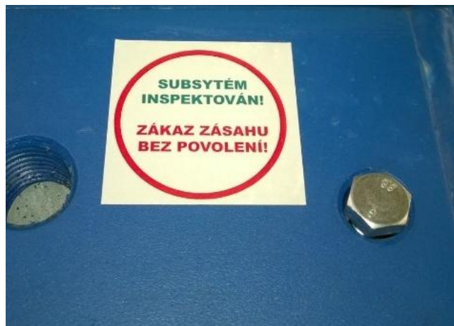
Obrázek 19 Ukázka označení subsystému pro provedené inspekce [25]
