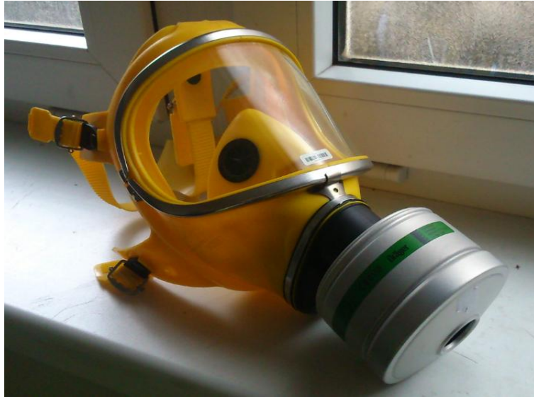
Obrázek 4 – Protiplýnová maska se dvěma filtry „K“ proti čpavku [Zdroj: autorka]
