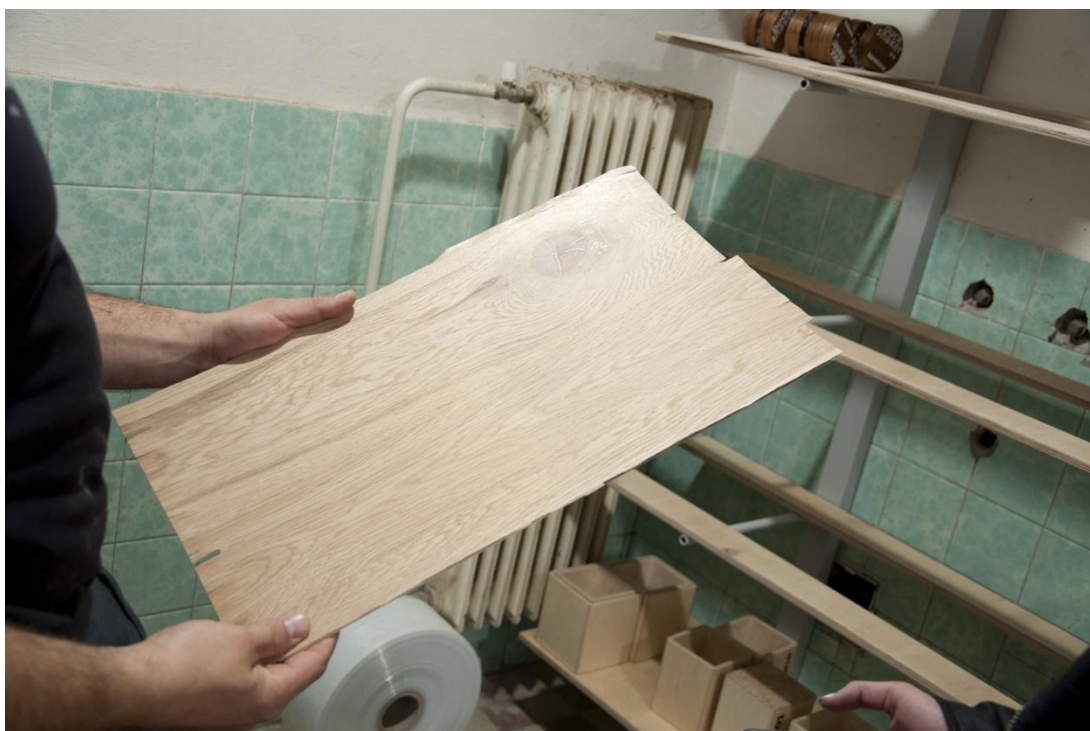
Obr. 66. deska s nalepenou bukovou dýhou, výrobní firma Tomtone
