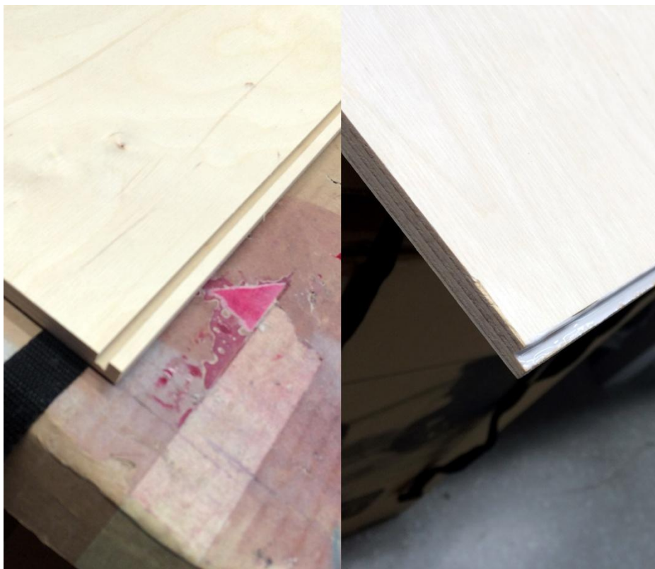
Obr. 52. Desky se zámkem: nalevo – podstava, napravo zadní deska
