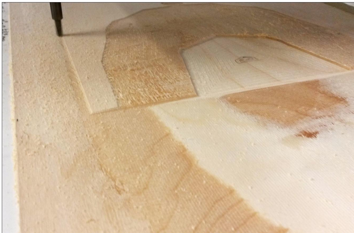
Obr. 57. Postupné frézování desky na CNC stroji
