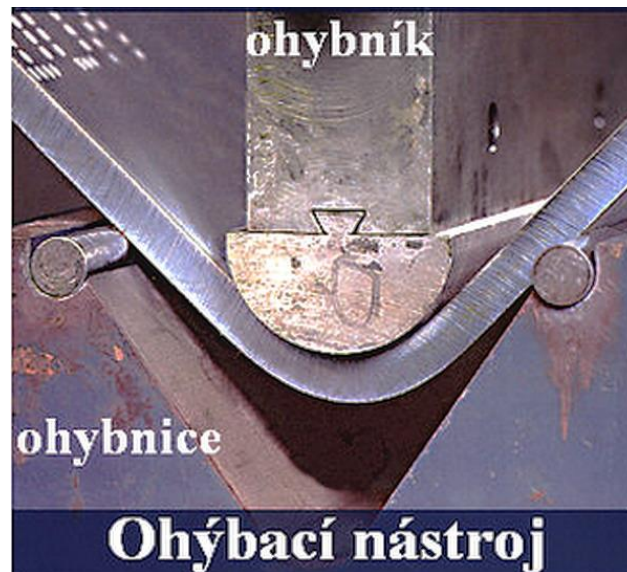
Obr. 31. Ohýbací nástroj zložený z ohybníka a ohybnice
