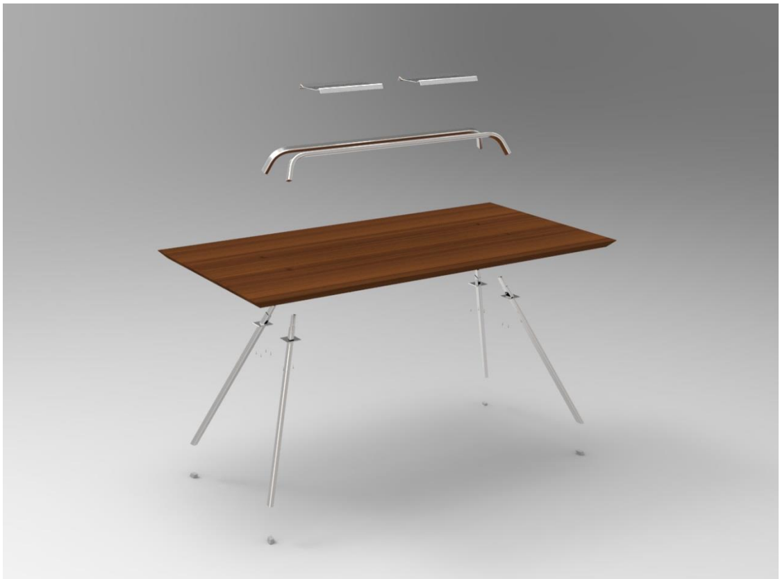
Obr. 54. Rozložená konstrukcia stola
