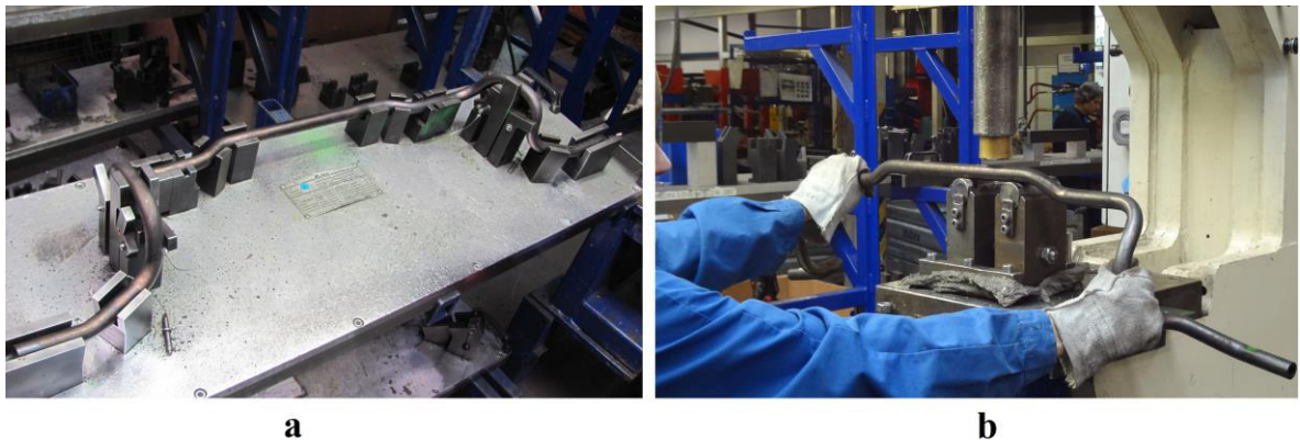
Obr. 55 Proces rovnání; a – rovnací lehry; b – rovnání pomocí lisu
