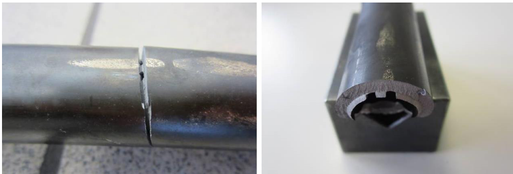
Obr. 75 Předčasný lom neshodného materiálu
