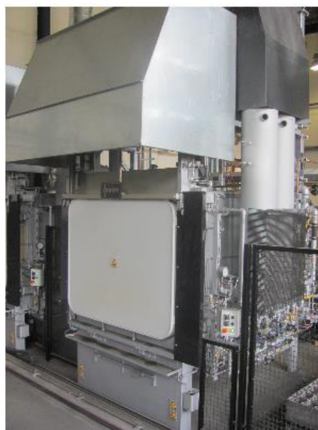
Obr. 49 Popouštěcí pec; a – schéma [35]; b - fotografie
