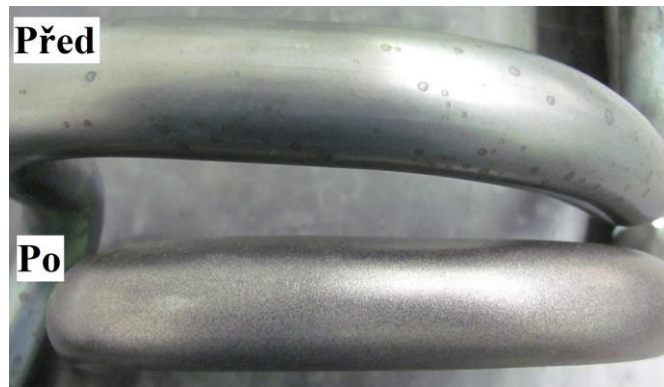
Obr. 58 Vzhled povrchu před a po tryskání
