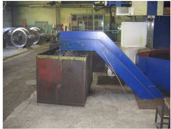
Obr. 22: Súčasnú umiestnenie kontajnera k stroju (vľavo) a navrhovaný dopravník na piliny (vpravo) [vlastné spracovanie]
