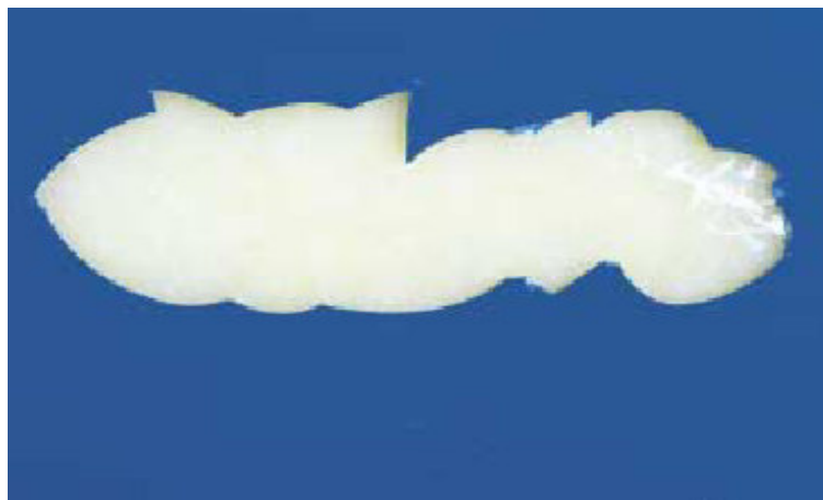
Obr. 14 : Nízká adheze gelcoatu k povrchu
