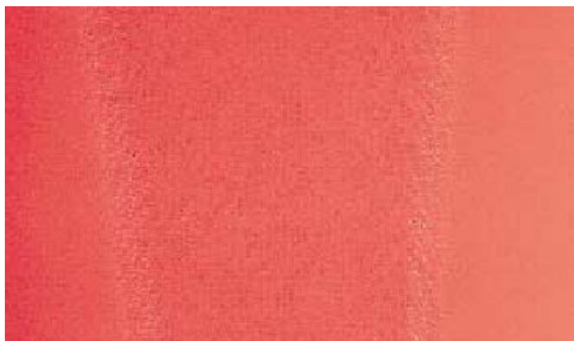
Obr. 18 : Separace pigmentu z povrchu gelcoatu
