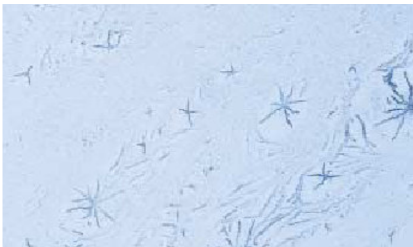
Obr. 23 : Gelcoat obsahující prach a jiné nečistoty
