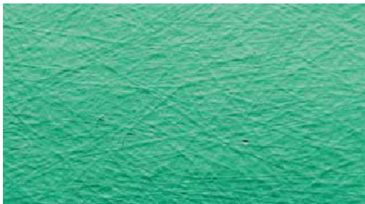
Obr. 21 : Viditelná vlákna výztuže resp. Fibre pattern na povrchu gelcoatu
