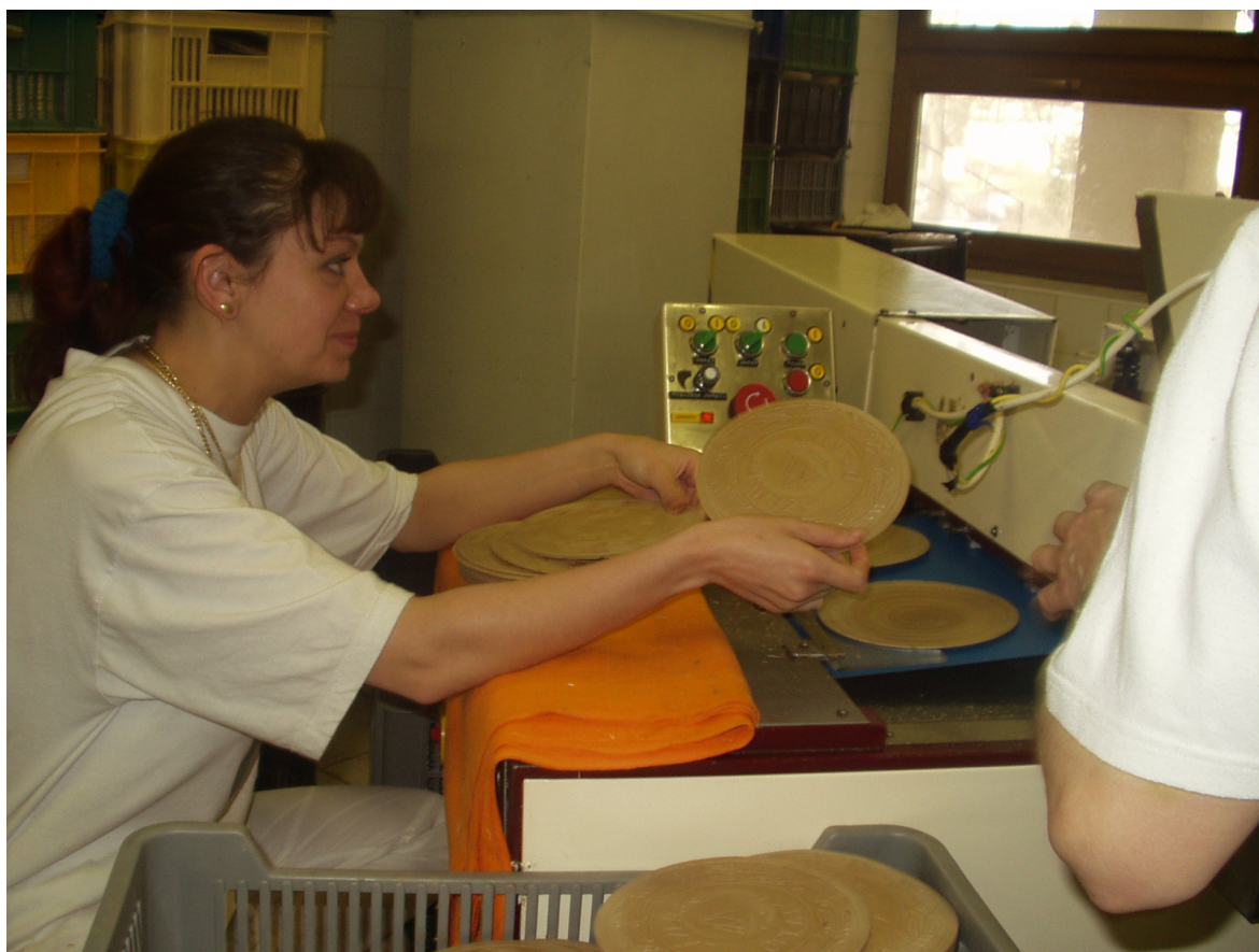
Obr. 3 – Vkládání suchých oplatků do mazacího stroje [vlastní zpracování]
