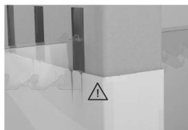
zařazte mírným tlakem do naseknutých drážek push it down lightly inside the slots
