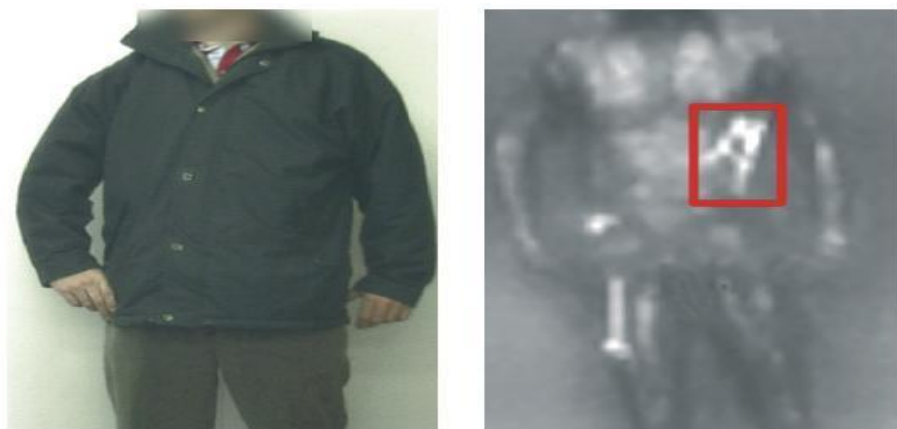
Obrázek č. 12: Příklad použití milivize a pořízený snímek [Zdroj: 3]
