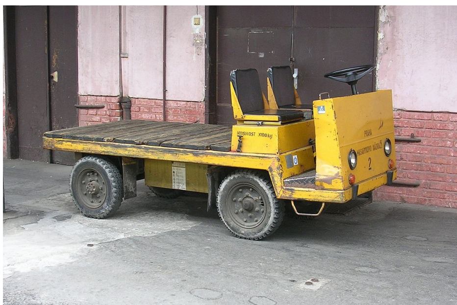
Obr. 9: Pozdější akumulátorový vozík Balkancar s ekonomicky řešeným oplechováním [13]
