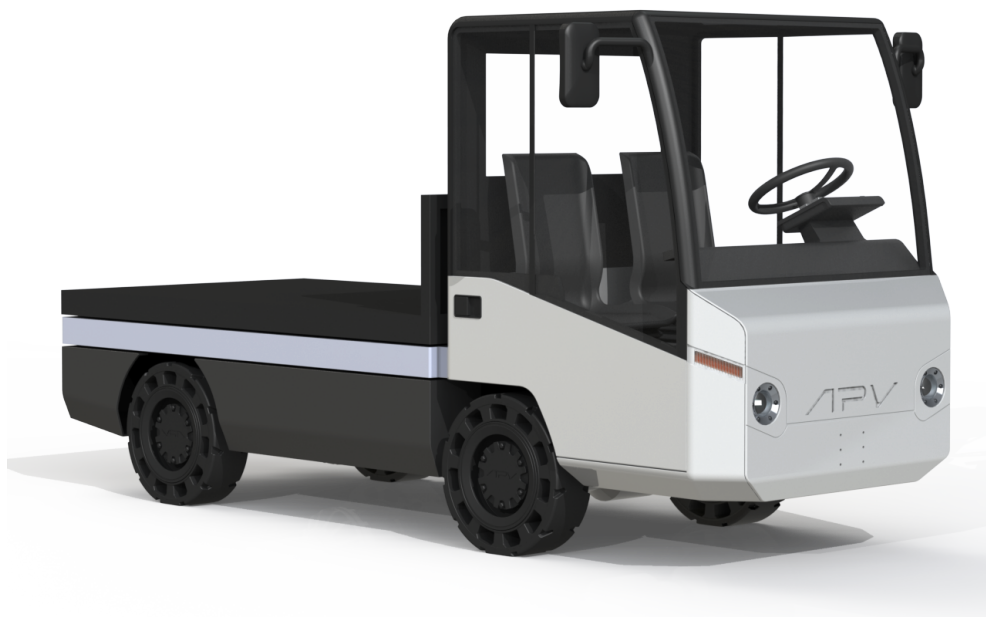
Obr. 56: APV se zvýšenou světlou výškou
