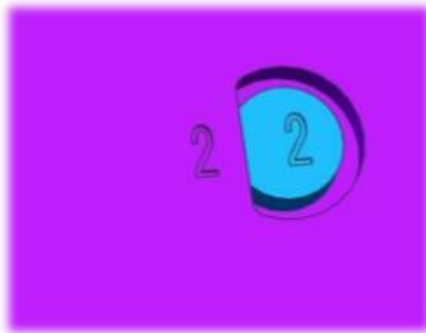
Obr. 19. Válcový vyhazovač s pojištěním proti pootočení [14]
