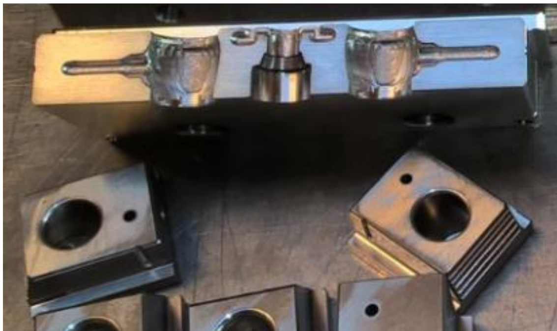
Obr. 49. Boční posuvné čelisti před hloubením
