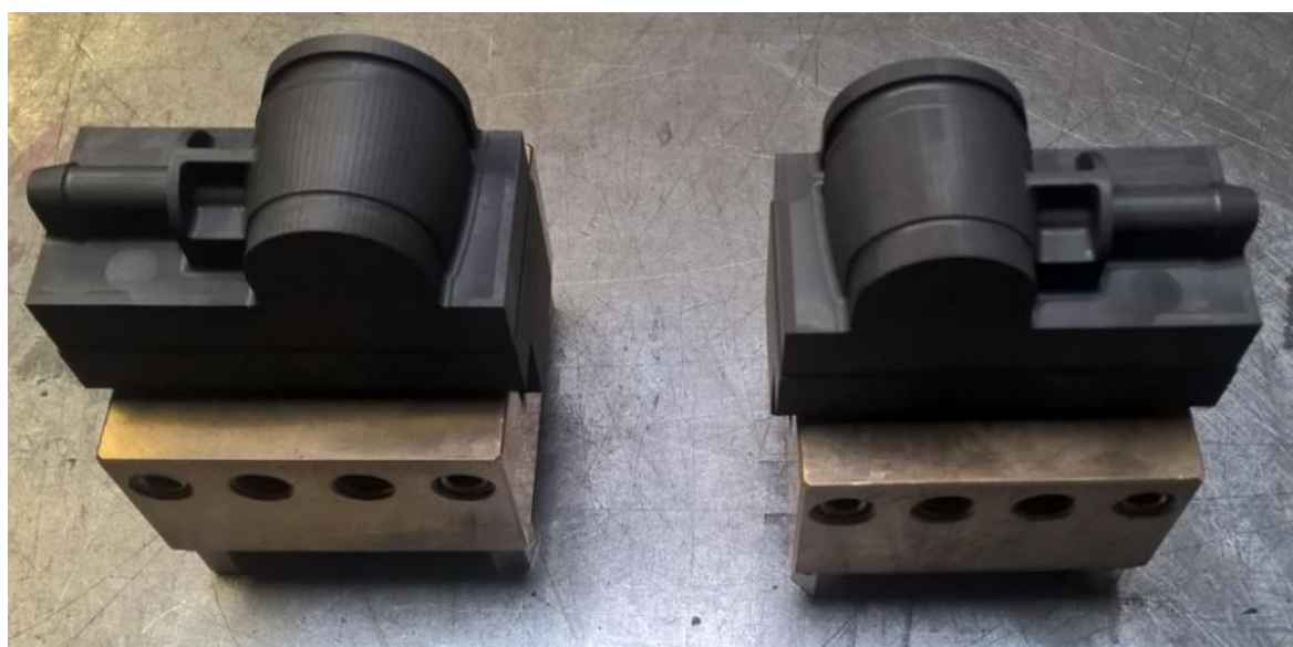
Obr. 50. Elektrody pro tvar na bočních posuvných čelistech
