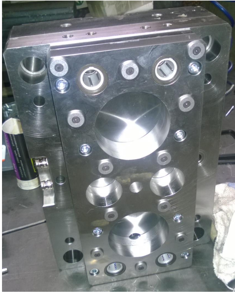
Obr. 53. Pohled na vyhazovací paket při montáži
