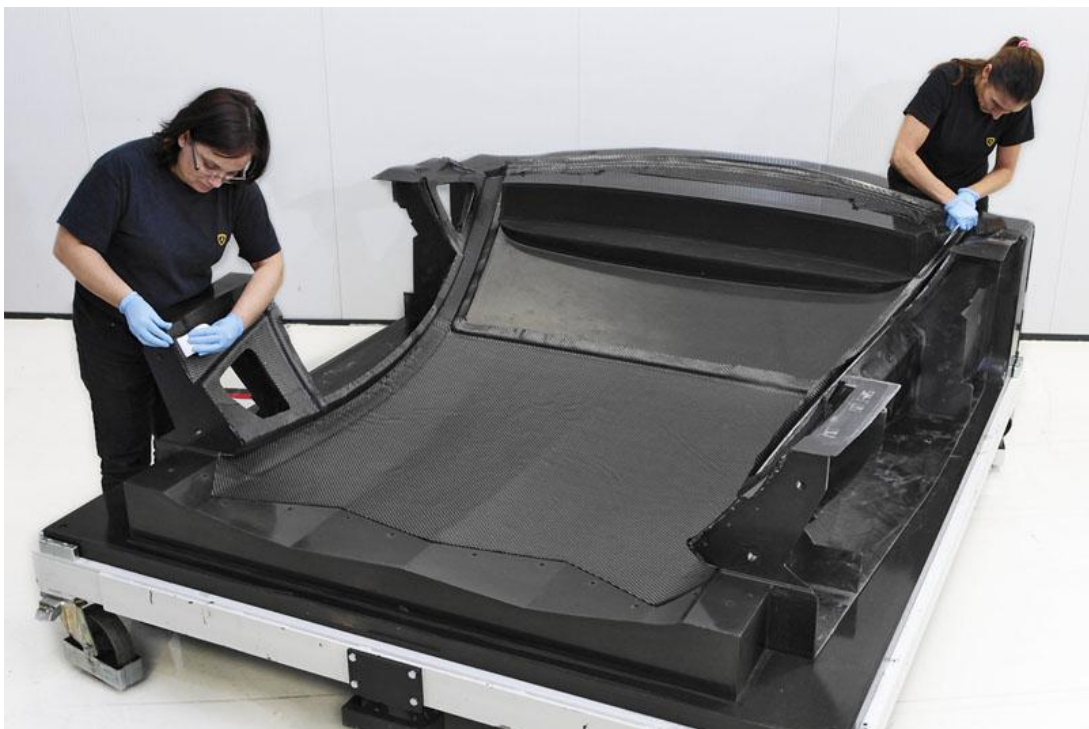
Obr. 17. Příklad ručního laminování střechy na Lamborghini [17]
