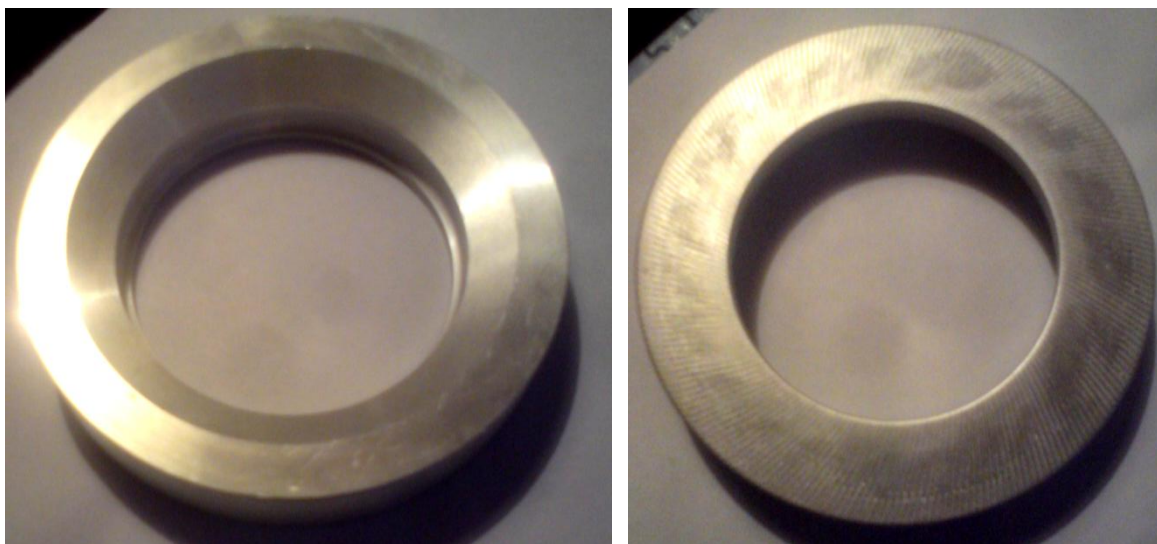
Obr. 63. Kroužek jako výztužné jádro středu disku
