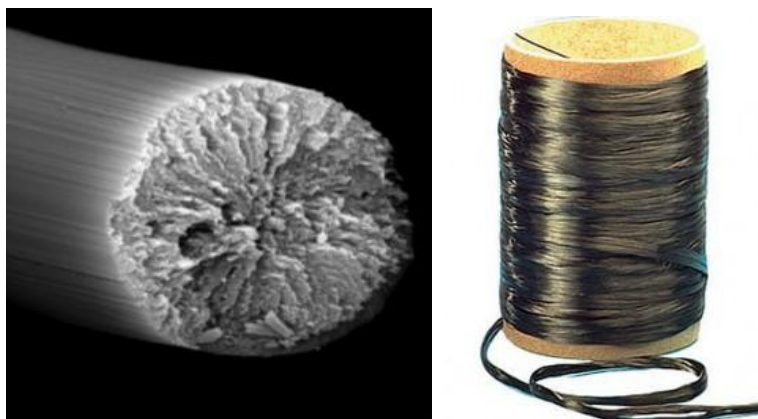
Obr. 8. Nalevo řez uhlíkovým vláknem a napravo cívka s tímto vláknem [5], [6]
