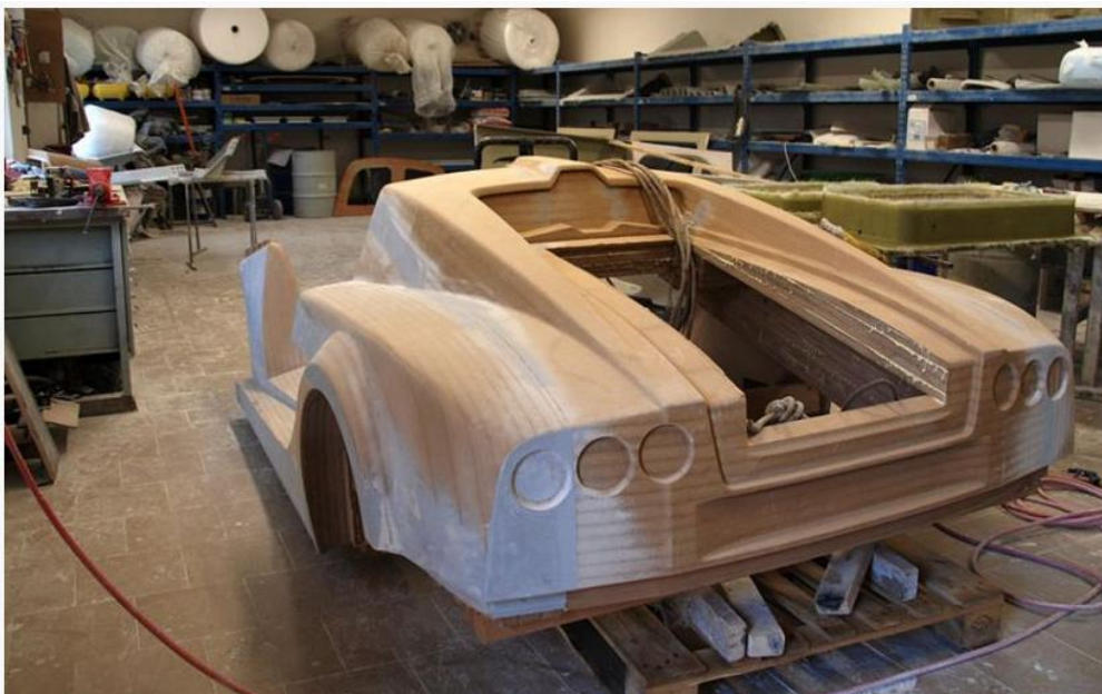
Obr. 24. Obrobený skutečný model z MDF desek [25]
