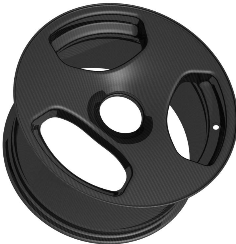
Obr. 35. Výsledný návrh karbonového disku
