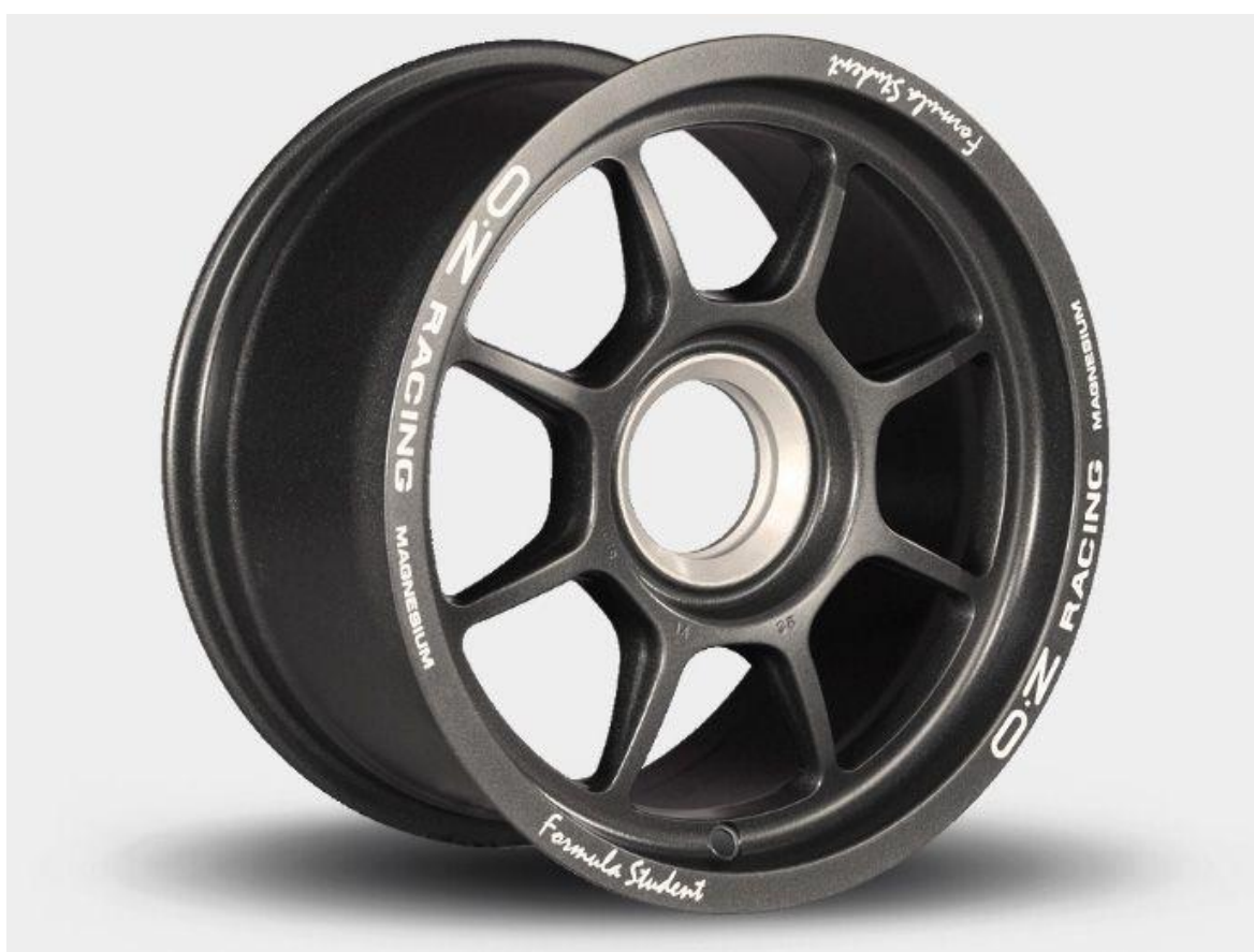
Obr. 36. Hořčíkový disk nyní používaný na student formuli ve VUT Brno
