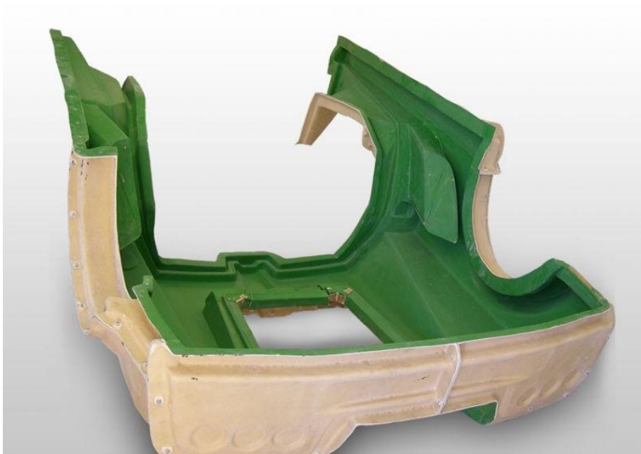
Obr. 25. Hotová kompozitní forma [25]
