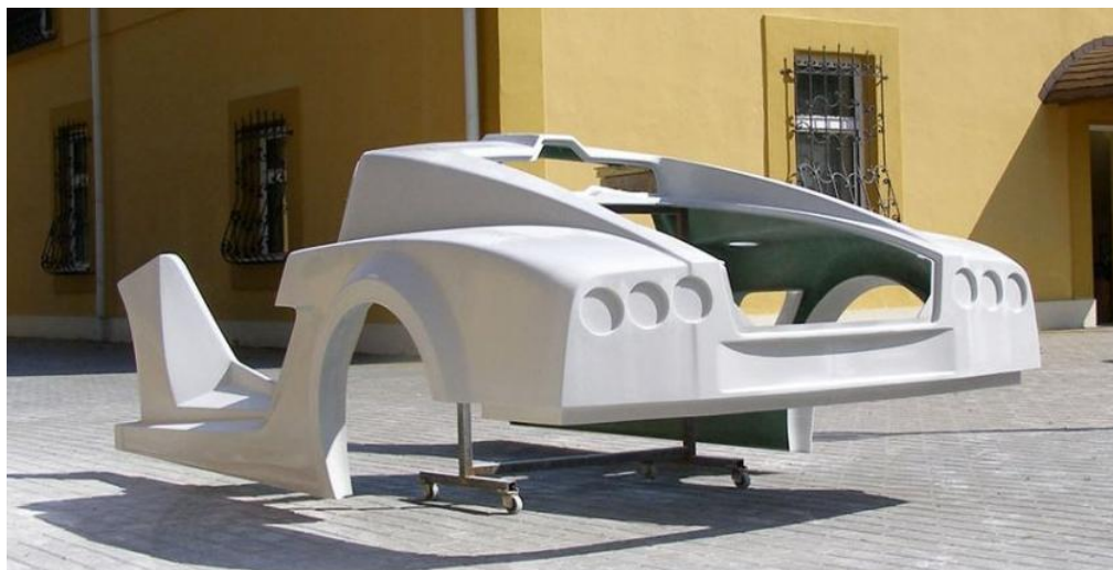
Obr. 26. Hotová kompozitní karosérie vozu [25]
