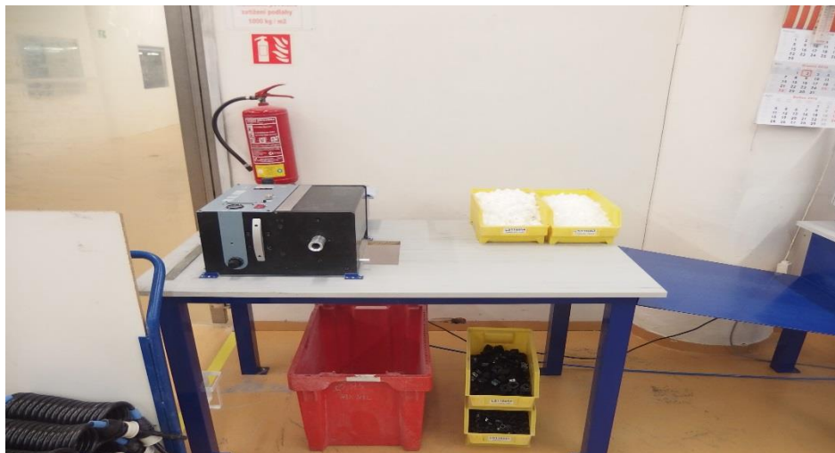
Obrázek 17 Odpláštění kabelů (vlastní fotografie)
