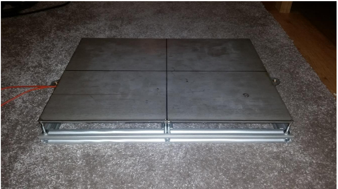
Obr. 37 Kompletně sestavený stůl osy Z skládající se z vyhřívané desky, nerezového plechu a nosné konstrukce.
