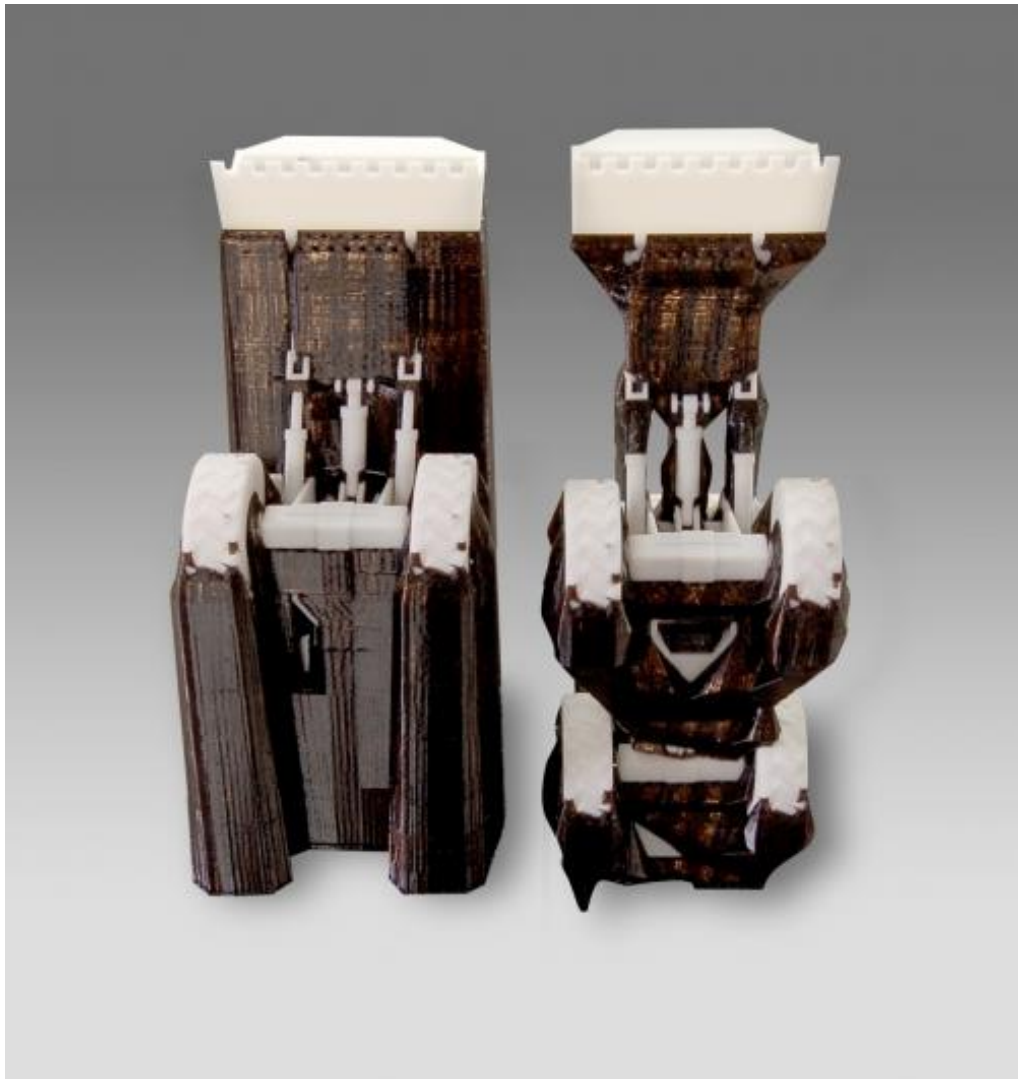
Obr. 10 Vlevo podpora Basic a vpravo Smart support [13]
