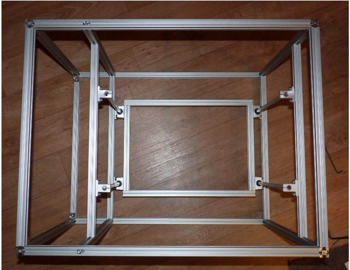
Obr. 35 Umístění osy Z do konstrukce stroje
