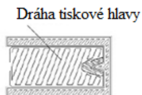
Obr. 12 Dráha tiskové hlavy při nanášení vlákna a zároveň struktura výrobku v jedné vrstvě [13]
