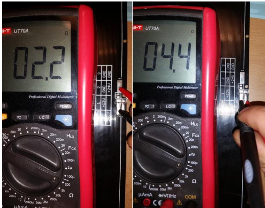
Obr. 57 Naměřené hodnoty odporů tiskové podložky pro 12 V a 24 V
