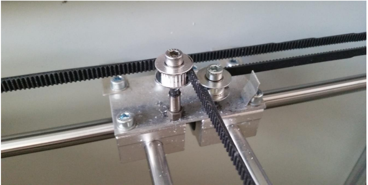
Obr. 39 Řemenice pro vedení ozubeného řemene sloužícího k pohybu tiskové hlavy a upravná lineární ložiska, která slouží zároveň jako držáky vodících tyčí osy Y
