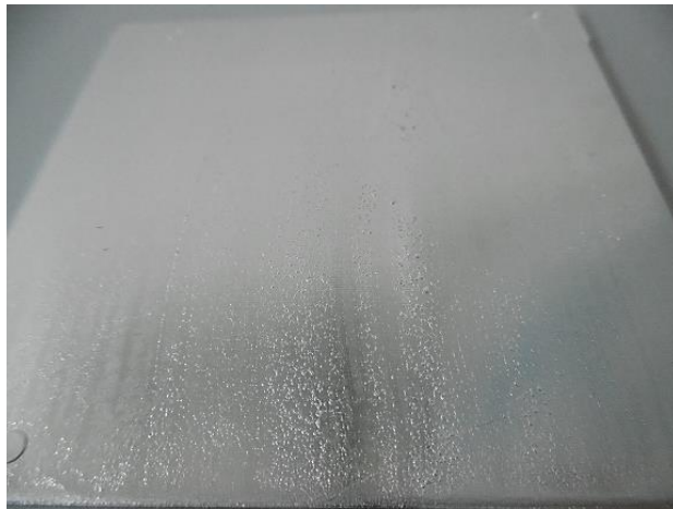
Obr. 46: Pokovené těleso po tepelném namáhání (degradácia povrchu)
