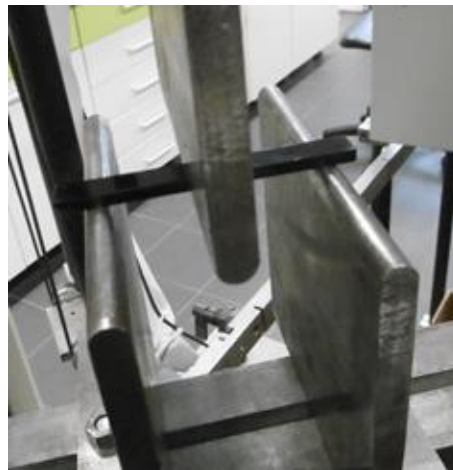
Obr. 38: Uloženie skúšobného telieska pri skúške ohybom
