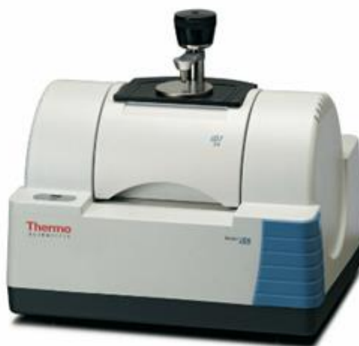
Obr. 44: Zariadenie pre FTIR spektroskopiou Nicolet iS5
