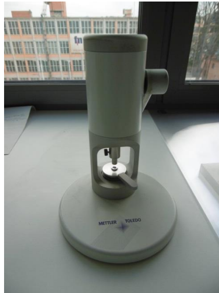
Obr. 35: Mechanické zariadenie na zalisovanie od firmy Mettler Toledo
