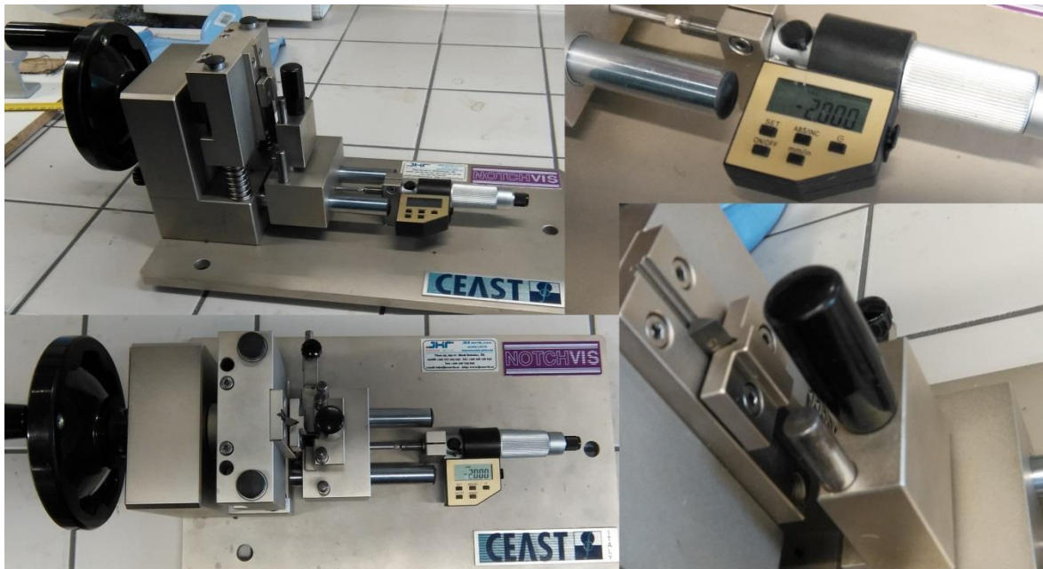
Obr. 32: Zariadenie na výrobu vrubov pre vrbovú skúšku Charpy-ho kladivom
