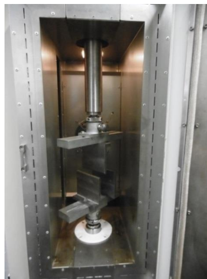
Obr. 39: Skúška ohybom v temperačnej komore
