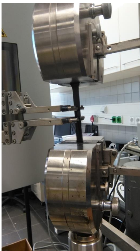
Obr. 37: Uloženie skúšobného telesa v čeľustiach stroja ZWICK ROELL 1456
