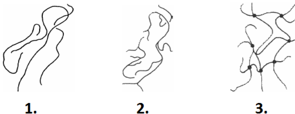
Obr. 6: Makromolekula 1.) lineárneho 2.) rozvetveného 3.) zosieťovaná
