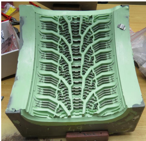
Obr. 27. Silikonová forma osazená lamelami.
