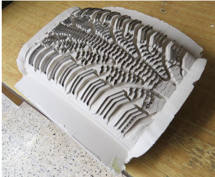
Obr. 29. Jádro osazené lamelami.
