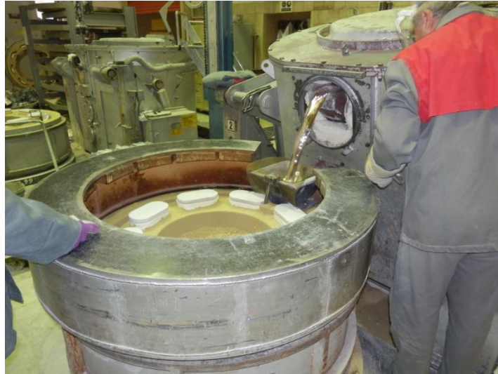
Obr. 30. Odlévání hliníkové slitiny.
