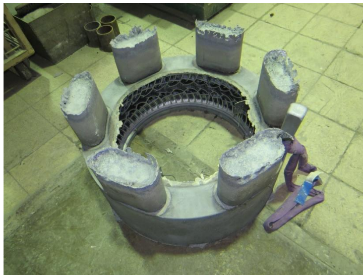
Obr. 31. Očištěný hliníkový blok s nálitky.
