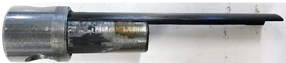
Porušení vzorku koncovky č. 1.
