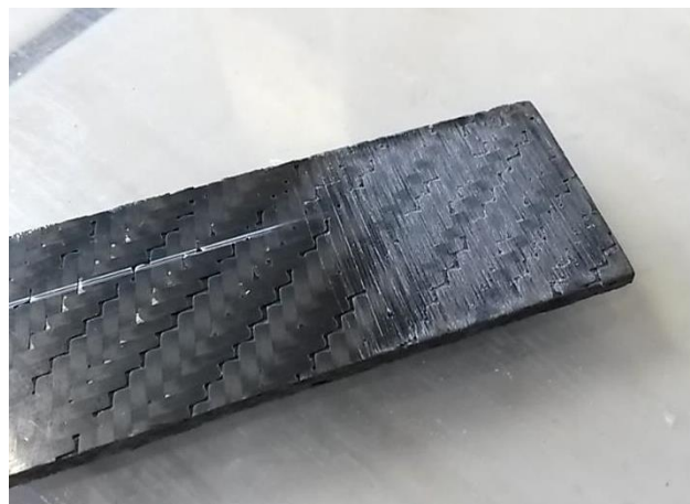
Detail zdrsnění laminátového panelu.
