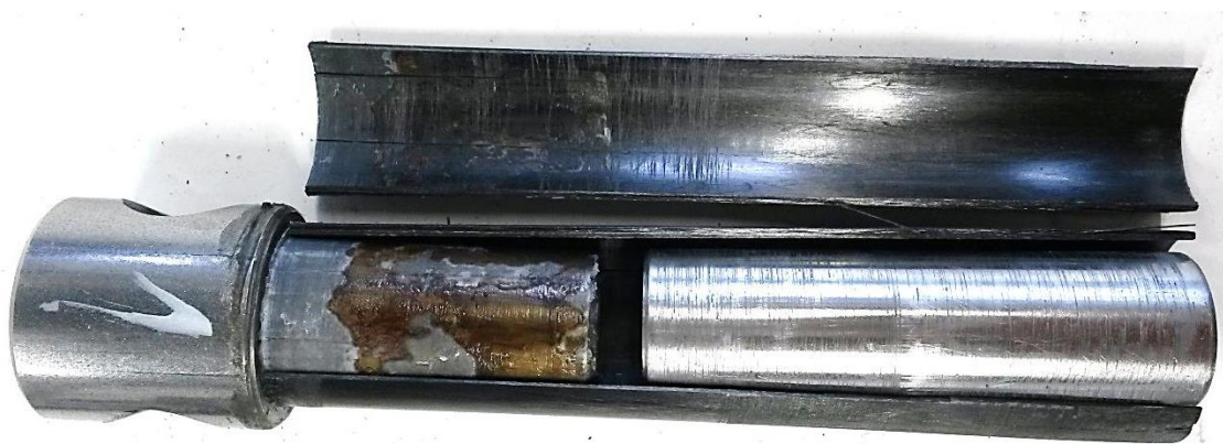
Obr. 47. Vzorek koncovky č. 1 po zkoušce, destrukce uhlíkové trubky, vložené výztužné válcové tělísko.
