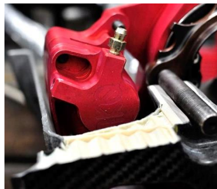
Obr. 13. Pohled na vnitřní strukturu uhlíkovo-sendvičového disku. [26]
