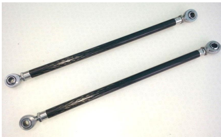
Obr. 14. Uhlíkové tyče náprav s ocelovými koncovkami. [8]
