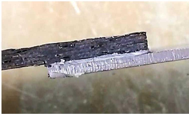
Obr. 36. Detail přeplátování lepeného spoje.
