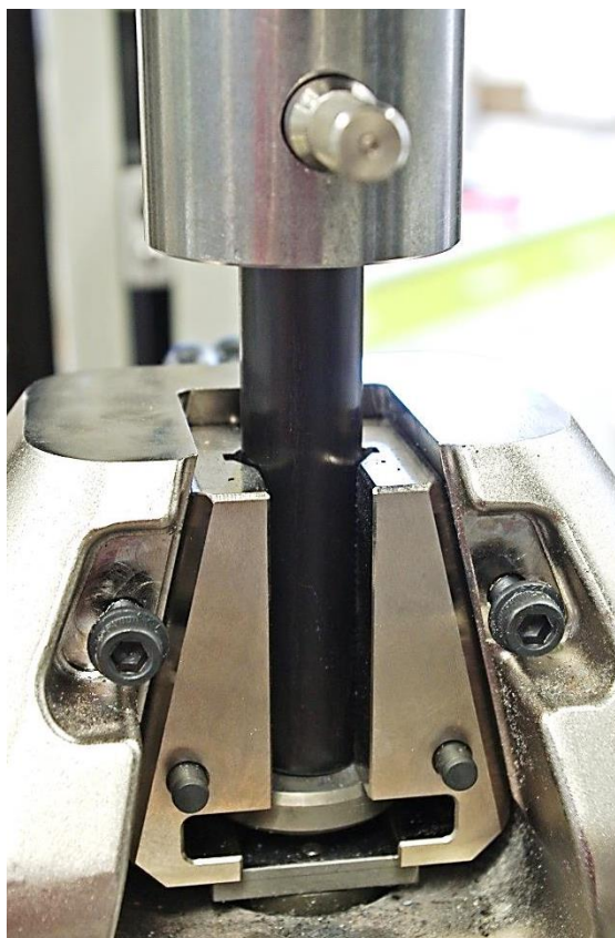
Obr. 46. Detail upnutí vzorku trubky v čelistech zkušebního stroje.
