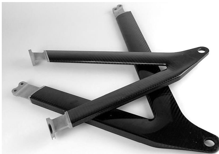
Obr. 16. Aerodynamická ramena nápravy zakončená pružnými ocelovými břity. [9]
