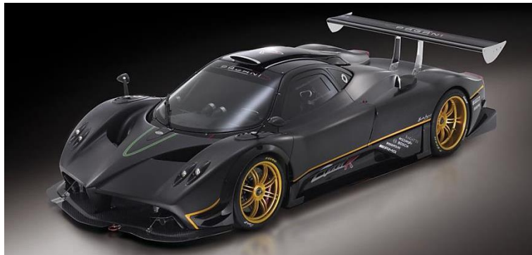
Obr. 7. Závodní automobil Pagani Zonda R s uhlíkovotitanovým monokokem a karoserií. [19]
