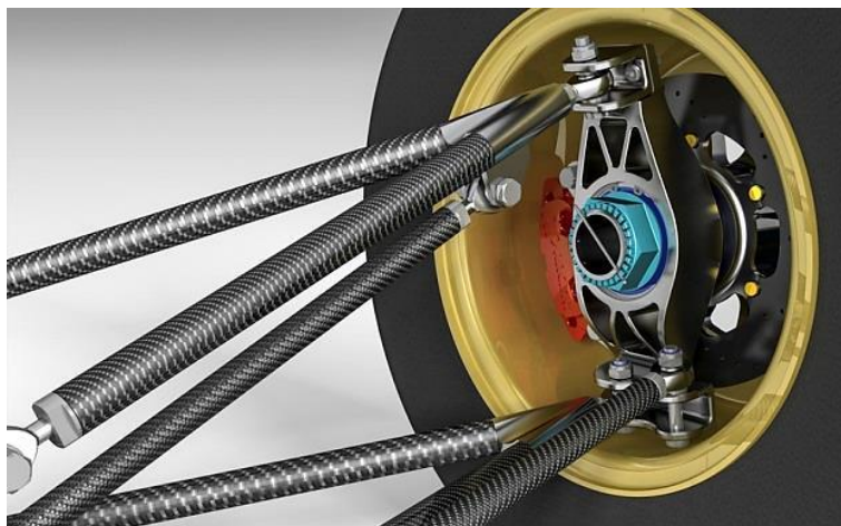
Obr. 15. Grafika uhlíkových ramen náprav se dvěma druhy kovových koncovek. [8]
