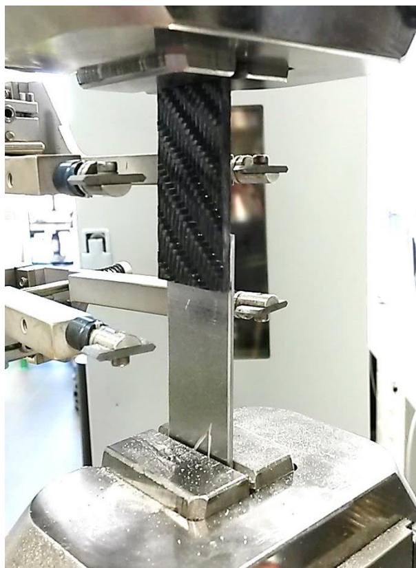
Obr. 45. Detail upnutí vzorku lepidla v čelistech zkušebního stroje.
