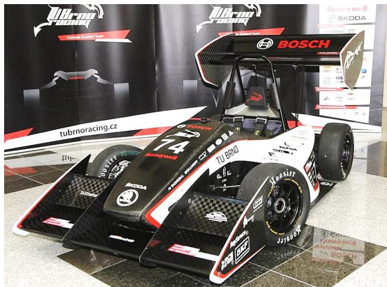
Obr. 6. Formule Dragon 4 univerzitního týmu TU Brno Racing s uhlíkovým monokokem a uhlíkovými přitlačnými křídly. [14]
