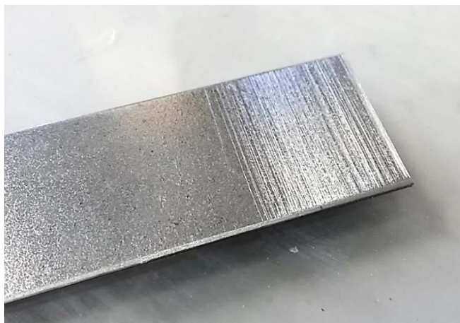
Detail zdrsnění ocelového panelu.
