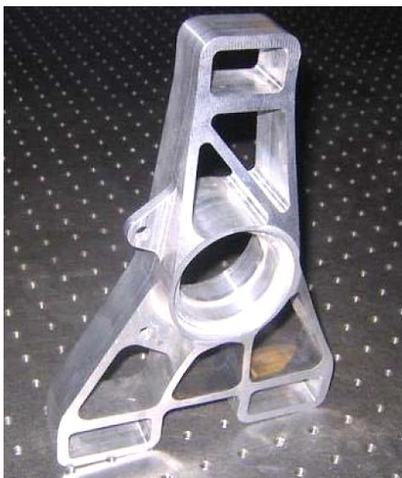
Obr. 4. Těhlice vozidla Formule Student vyrobená obráběním z hliníkové slitiny. [10]
