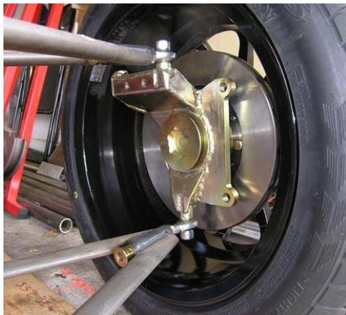
Obr. 2. Detail uchycení ocelových ramen k těhlici vozidla Formule Student. [8]
