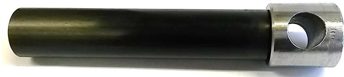
Obr. 41. Zhotovený zkušební vzorek trubky s vlepenou koncovkou.
