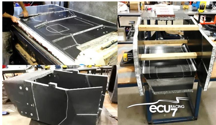
Obr. 8. Výroba hybridního monokoku z hliníkových sendvičových desek pro formuli Emma MT7 konstrukčního týmu Edith Cowan University Racing. [22]
