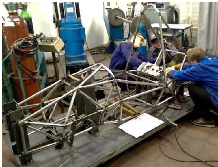
Obr. 1. Svařovaný rám Formule Student konstrukčního týmu univerzity v Oulu, Finsko. [7]
