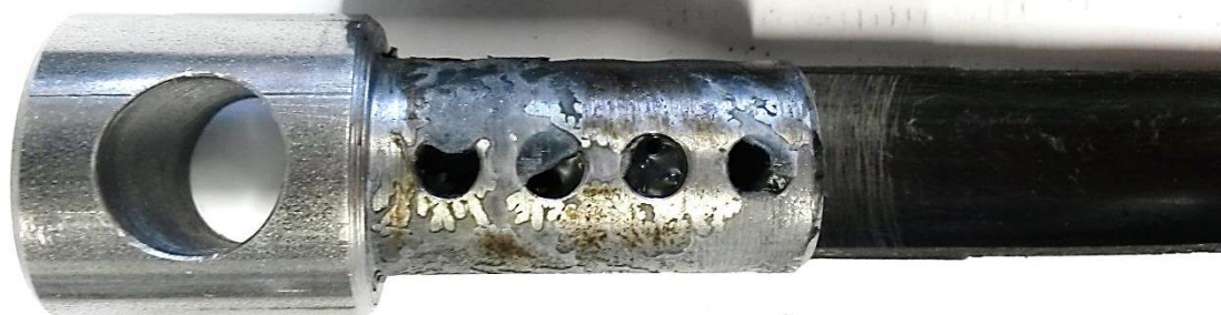
Porušení vzorku koncovky č. 4.
