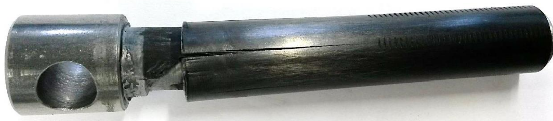
Porušení vzorku koncovky č. 3.
