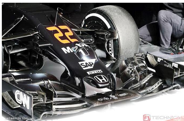
Obr. 10. Přední přitlačné křídlo vozidla Formule 1 značky McLaren MP4-31 vyrobené z uhlíkového kompozitu. [25]
