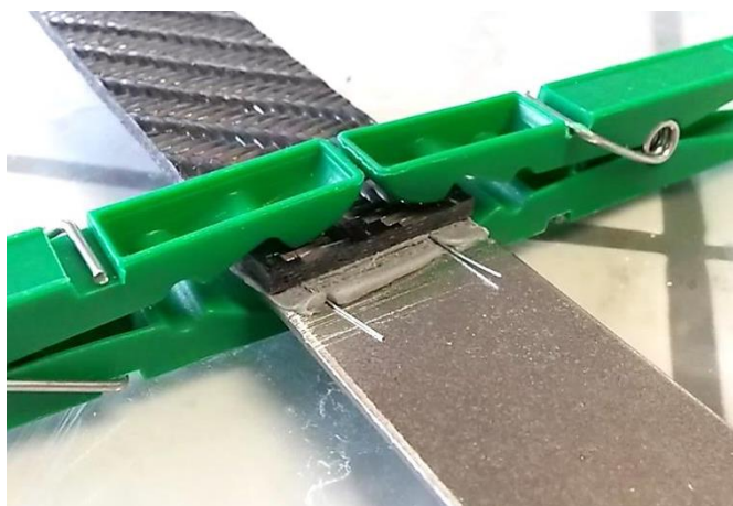
Detail zafixování panelů po nanesení lepidla.
