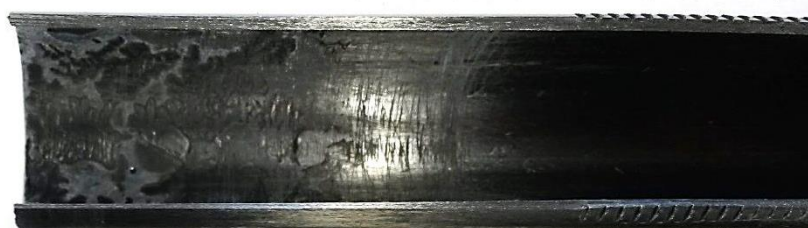
Porušení vzorku koncovky č. 1.
