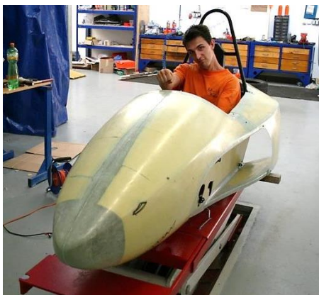
Obr 9. Sklolaminátová kapotáž závodního vozu Dragon 1 týmu TU Brno Racing. [23]
