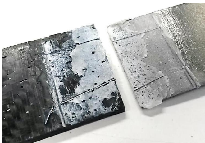
Porušení lepeného spoje vzorku lepidla D.
