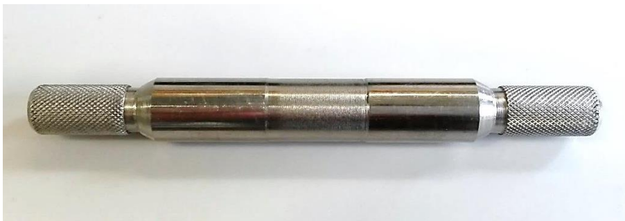
Obr. 38. Čep pro uchycení koncovky k rámu zkušebního stroje.
