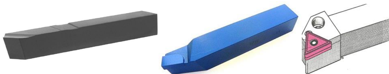
a) b) c) Obr. 10 Ukázka nástrojů dle konstrukce a) celistvý, b) s pájenou břitovou destičkou, c) s mechanicky připevněnou břitovou destičkou
