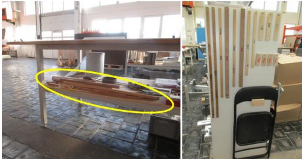
Obr. 61. Uložení přípravků pro výrobu „před a po“ 5S (vlastní zpracování)
