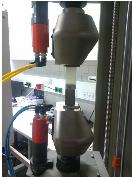
Obr.33: Upnutí vzorku do čelistí stroje
