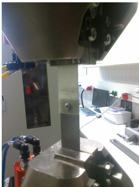
Obr.31 Střih zkušebního vzorku s nýtem
