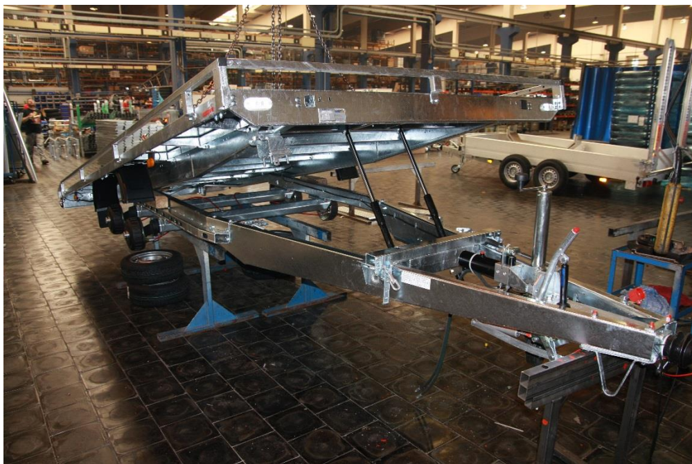
Obrázek 40: Spojení nosného rámu a rámu sklopné korby (vlastní zpracování)
