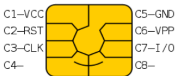
Obr. 3. Uloženie a priradenie kontaktov na čipovej platobnej karte
