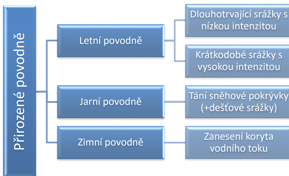
Obr. 3. Rozdělení přírodních povodní [Zdroj: Vlastní]
