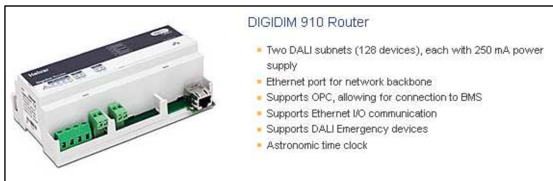
Obrázek 9 - DALI router, který podporuje až dvě DALI podsítě včetně jejich napájení a umožní připojení k nadřazené síti Ethernet (12).
