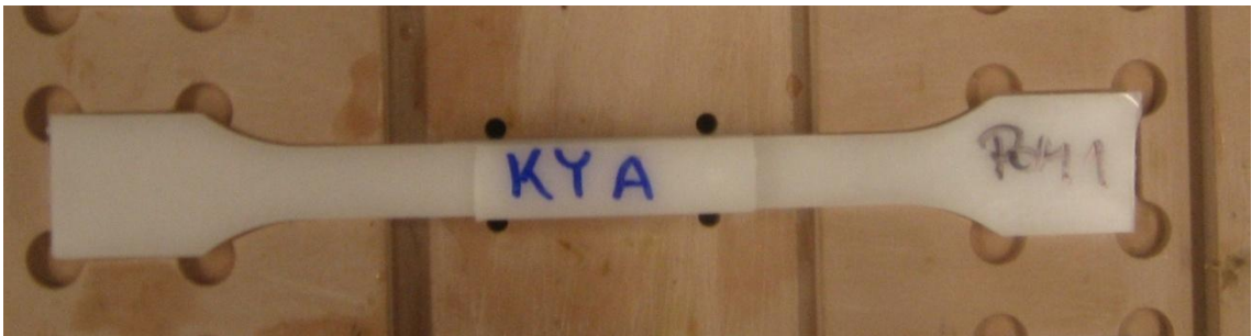
Obr. 25. Hotové zkušební těleso pro tahovou zkoušku.
