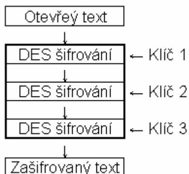
Obrázek 9 Schéma šifrování TripleDES
