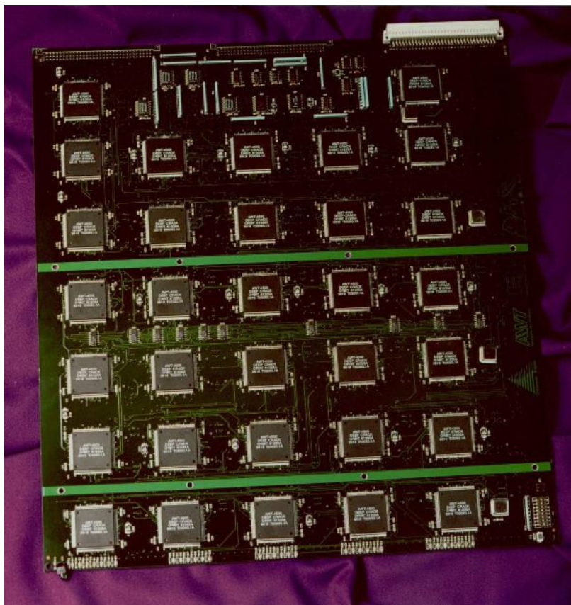
Obrázek 8 Jedna z 29 desek stroje DES-Cracker
