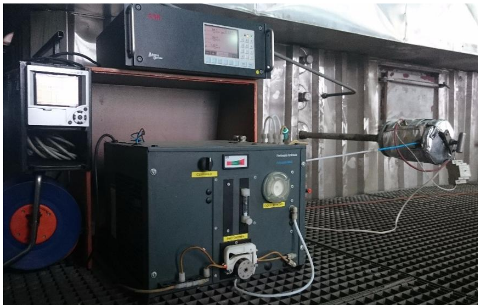
Obrázek 41 – Měření spalin externím analyzátozem plynů
