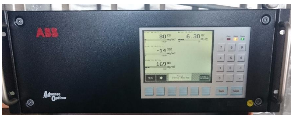
Obrázek 42 – Detail externího analyzátoru při měření koncentrace spalin
