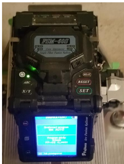
Obr. 31. Optická zvaračka FSM-60S
