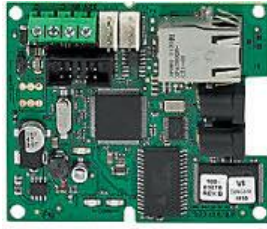
Obr. 51. Ethernet TCP/IP komunikátor [35]
