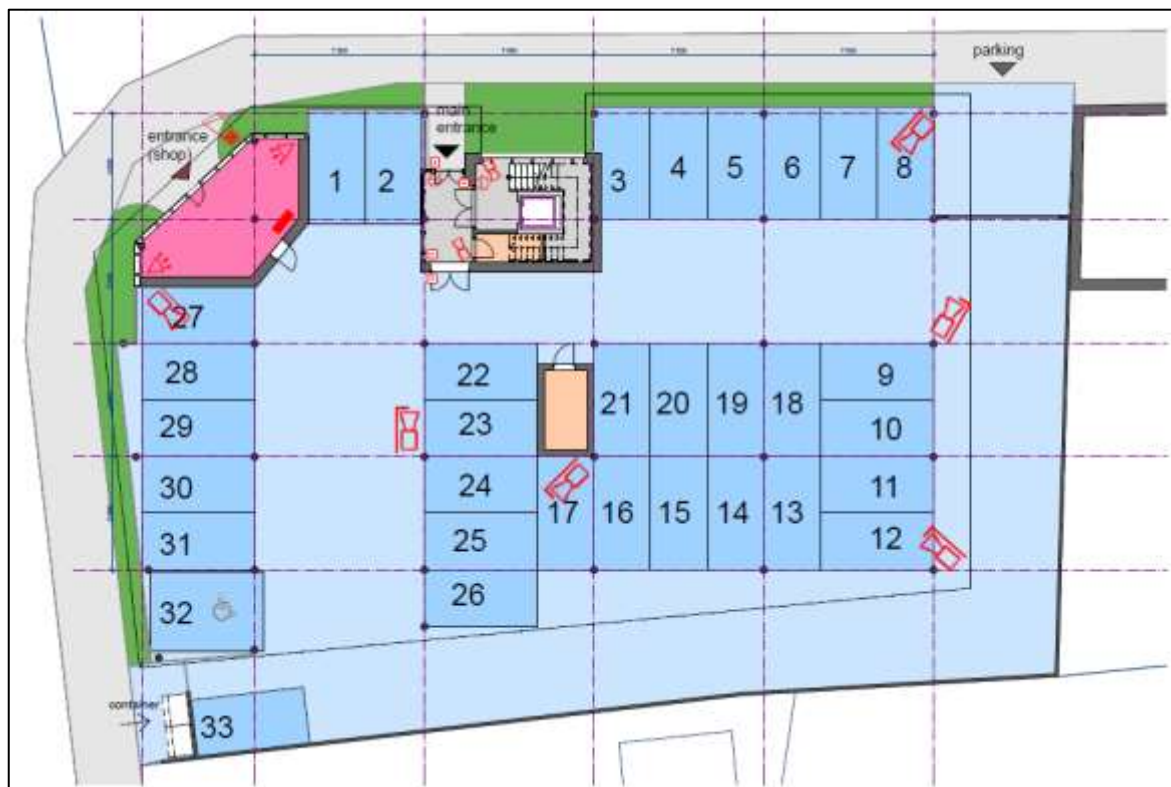
Obrázok 28. Návrh kamerového systému v bytovom dome na 1. NP.
