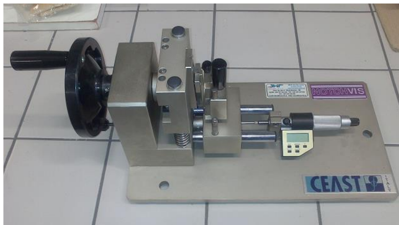
Obrázek 37 – Vrubovačka CEAST s mikrometrem
