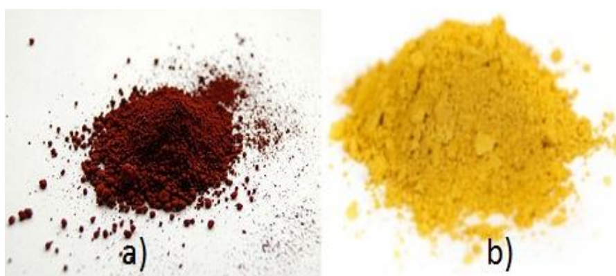
Obrázek 21 – Oxidy železa: a) bezvodý; b) zcela hydratovaný [49]
