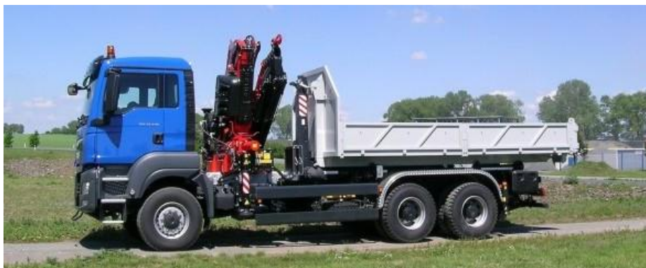
Obr. 2 - Přední montáž HNJ na kontejneru.
