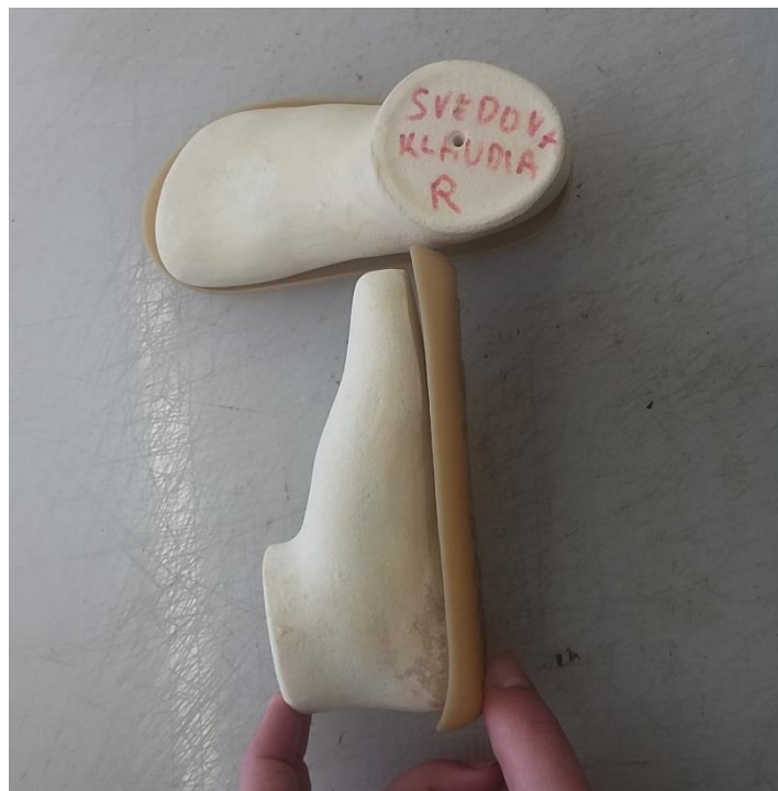
Obr. 19: Vyfrézované kopyto z firmy Protea.sk a podešev Bobux
