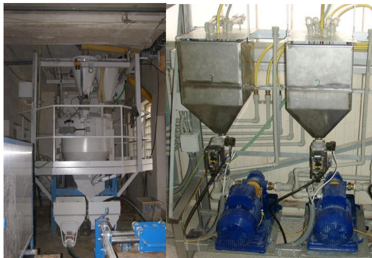
Obr. 19: Příklady dávkovacího a mísícího zařízení [36, 37].
