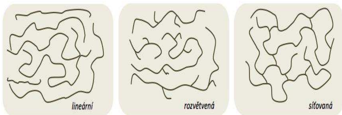
Obr. 5 Molekulární struktura polymeru
