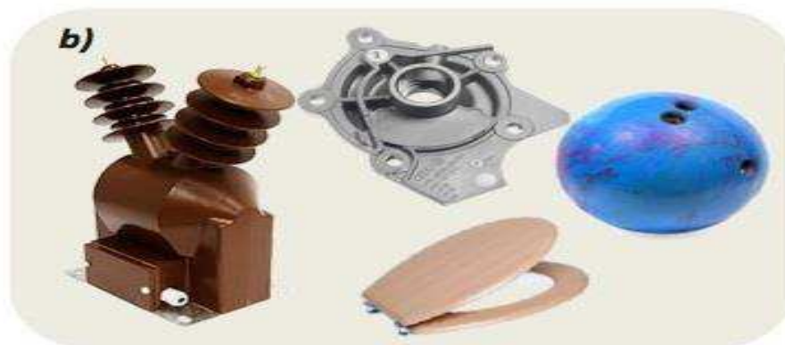
Obr. 3 Příklad využití reaktoplastů
