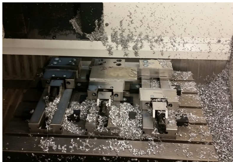
Obrázok 16 Frézovanie otvorov v obrábacom centre (vl. spracovanie)
