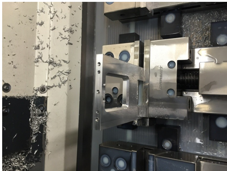
Obrázok 19 Uchytenie súčiastky SX210 v obrábacom centra (vl. spracovanie)
