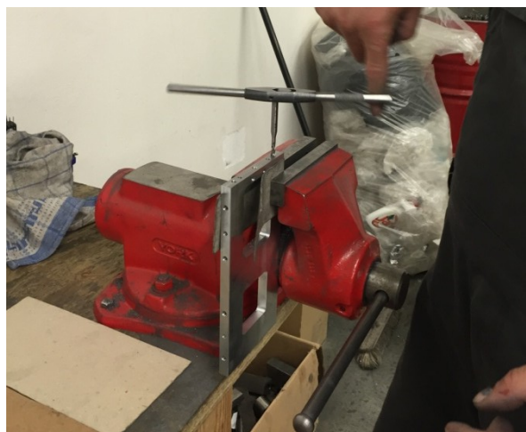
Obrázok 21 Vrtanie závitov (vl. spracovanie)
