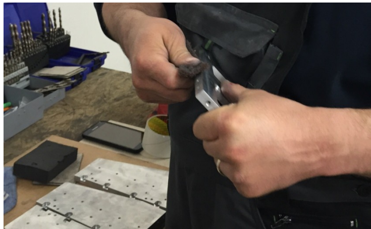
Obrázok 20 Ručné leštenie súčiastky (vl. spracovanie)
