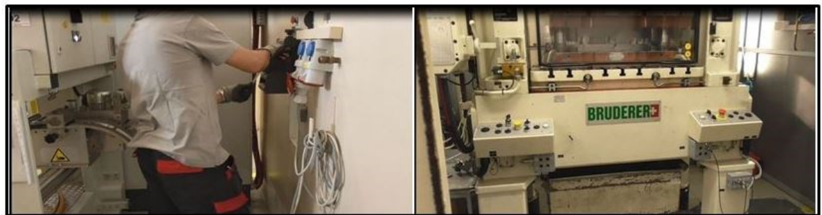
Obr. 13. Přivedení materiálu (pásku) do lisu a lisování (vlastní zpracování)
