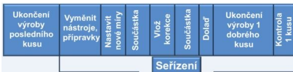
Obr. 5. Jednotlivé kroky seřízení (SMED, © 2012b)
