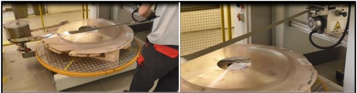
Obr. 12. Odvíjení materiálu (vlastní zpracování)
