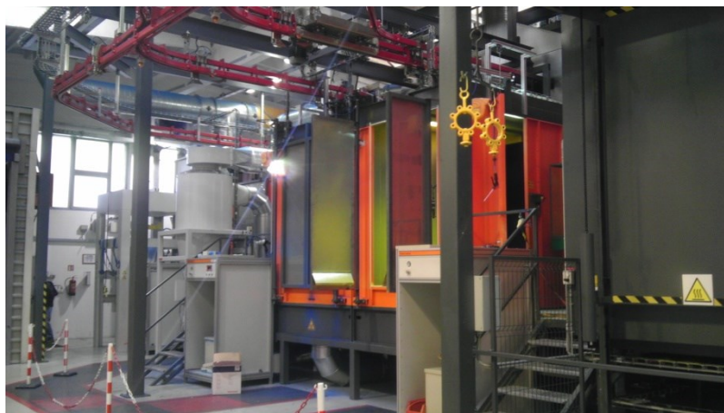
Obrázek 12 – Barvicí box na práškovou barvu (vlastní zpracování)
