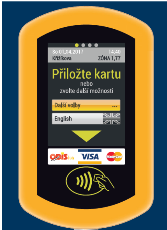
Obr. 6 Odbavovací panel v Moravskoslezské IDS (Dopravní podnik Ostrava, 2017)
