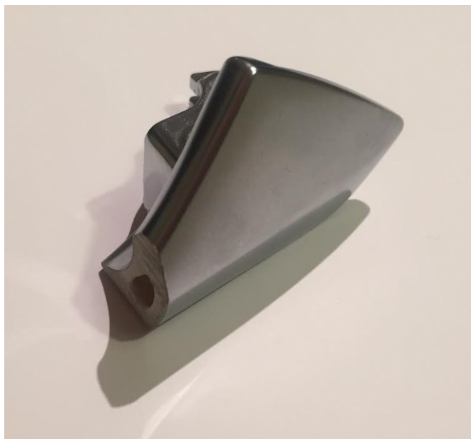
Obr. 4 Řez klikou dveří osobního automobilu vyrobenou technologií GIT
