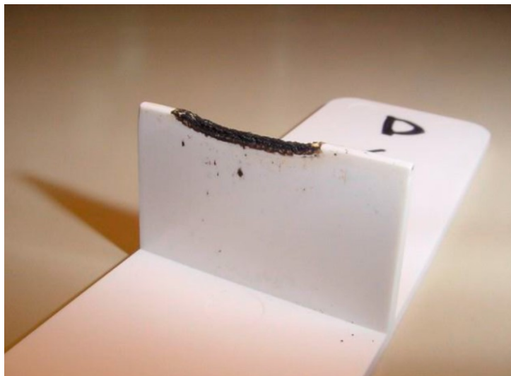
Obr. 13 Dieselefekt vlivem nedostatečného odvzdušnění formy [29]
