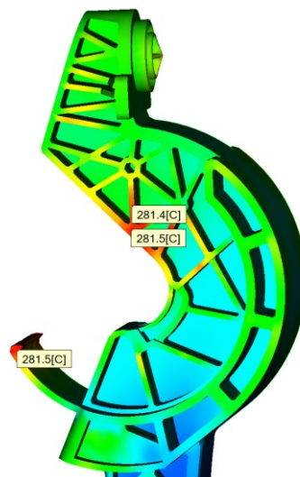
Obr. 48 Maximální teploty na čele taveniny – varianta 1
