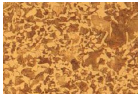
Obr. 23 Struktura Ferit – Perlit [16].
