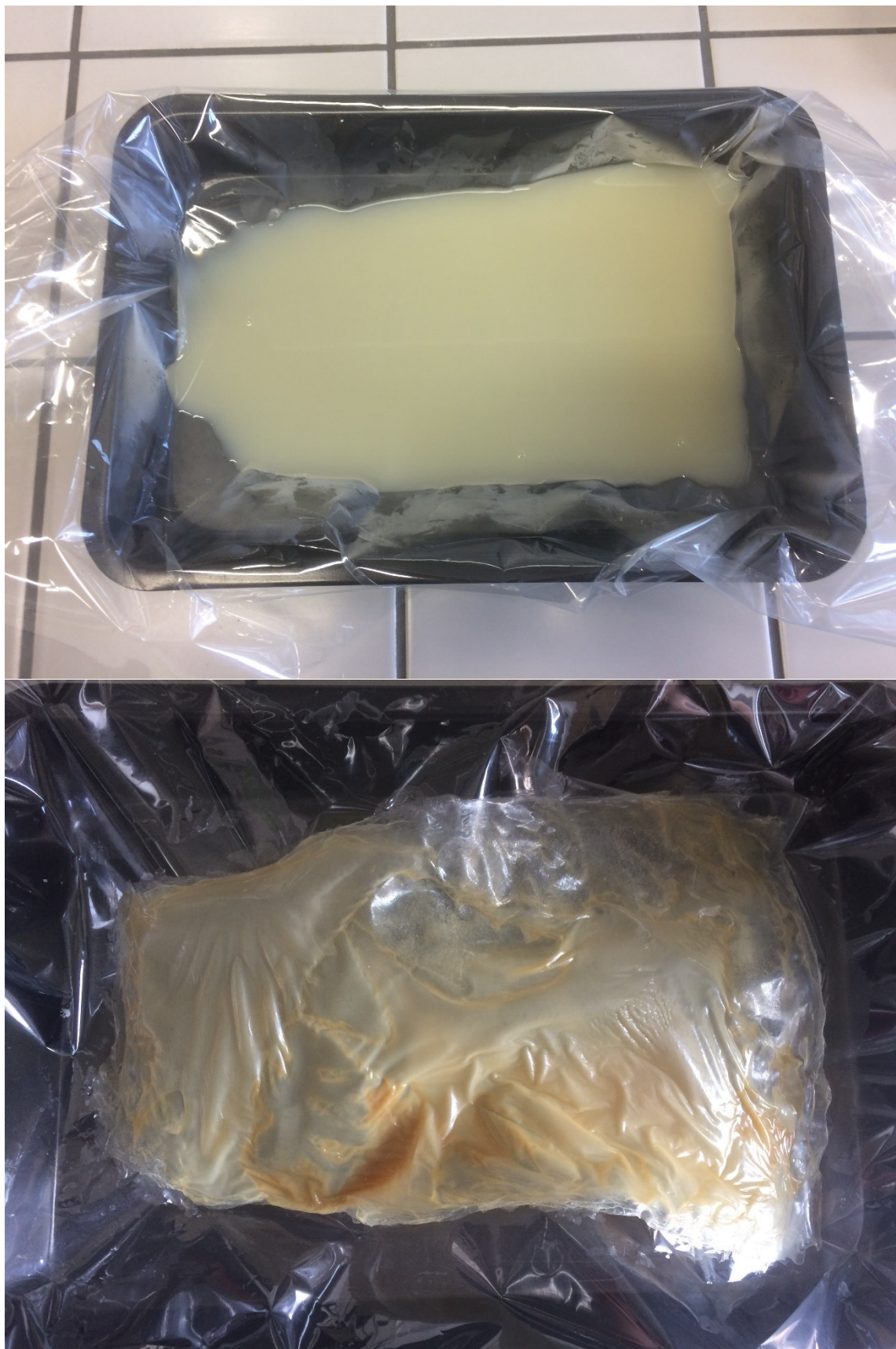
Obrázek č. 6 Vyextrahovaná želatina nalitá na plech před (nahore) a po sušení (dole)
