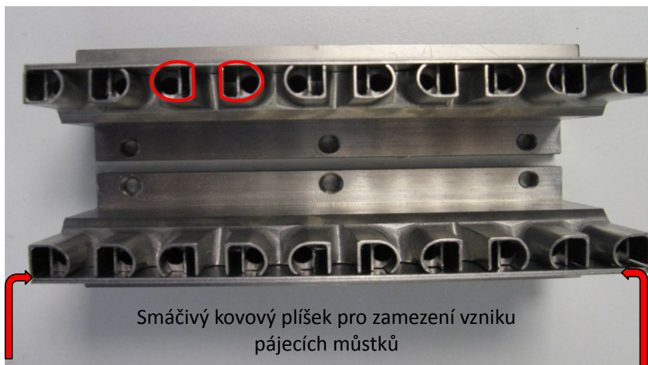
Obr. 44. Pájecí tryska - varianta 3 (pohled shora)
