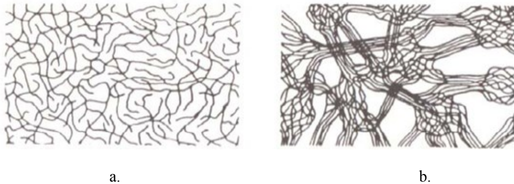
Obrázek 4. Struktura řetězců amorfnního a semikrystalického termoplastu [5]
