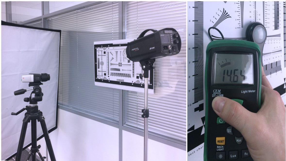
Obr. 30: Testovací sestava, naměřená hodnota intenzity osvětlení (zdroj: vlastní)
