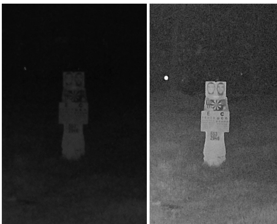
Obr. 46: Srovnání IR LED kamer Dahua a Dinox (zdroj: vlastní)
