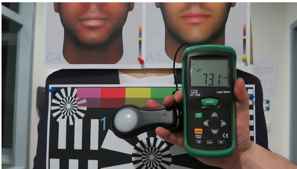
Obr. 37: Ukázka měření pomocí přístroje CEM DT-1308 (zdroj: vlastní)
