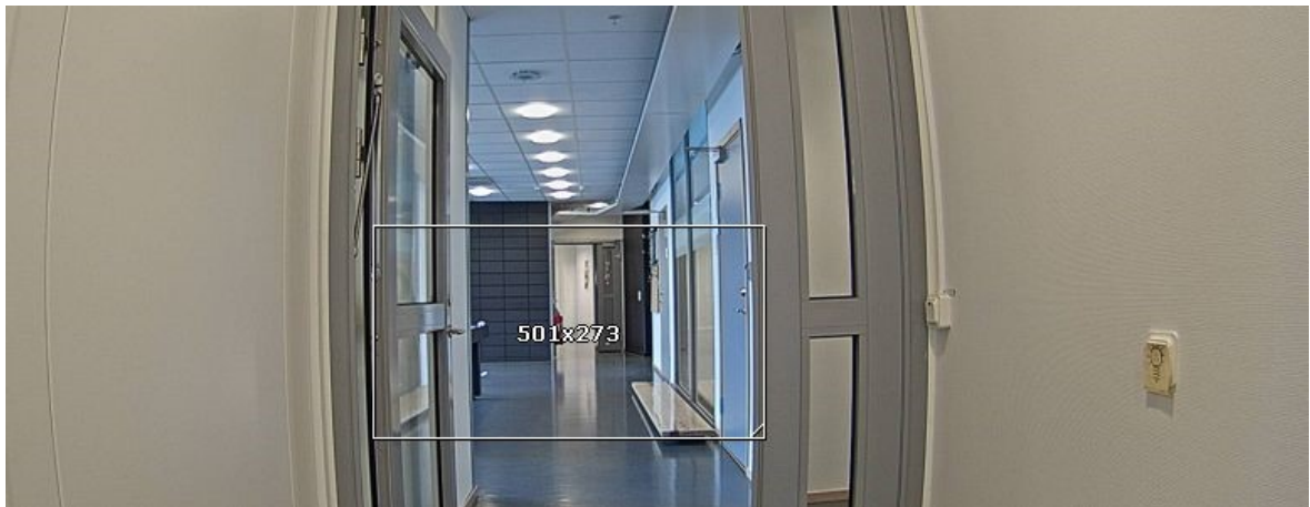
Obr. 3: Axis - stanovení stupně rozlišení dle známé velikosti objektu [7]
