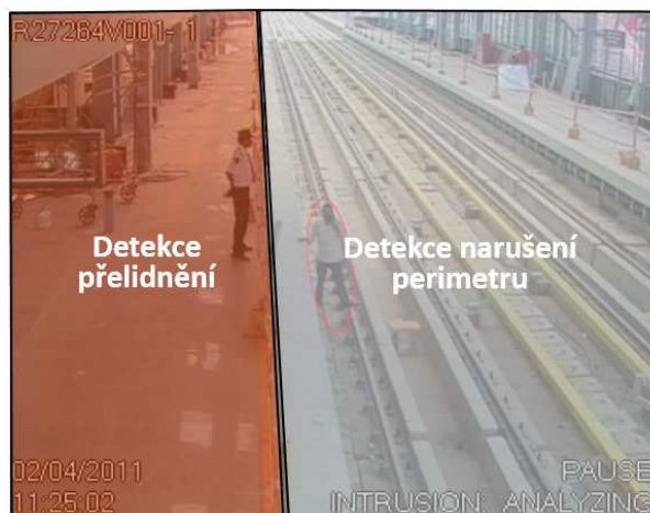
Obr. 31 Řešení několika událostí v rámci video detekce na jedné kameře [vlastní zdroj]
