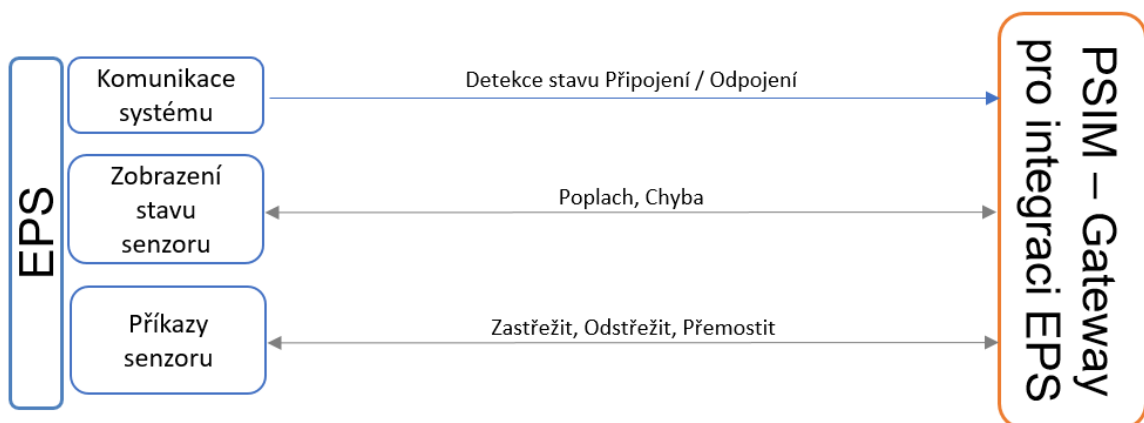
Obr. 24 EPS - datové zprávy a poskytované funkcionality [vlastní zdroj]
